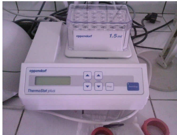
Fig. A.8 : Thermostat utilisé pour chauffer la trypsine
