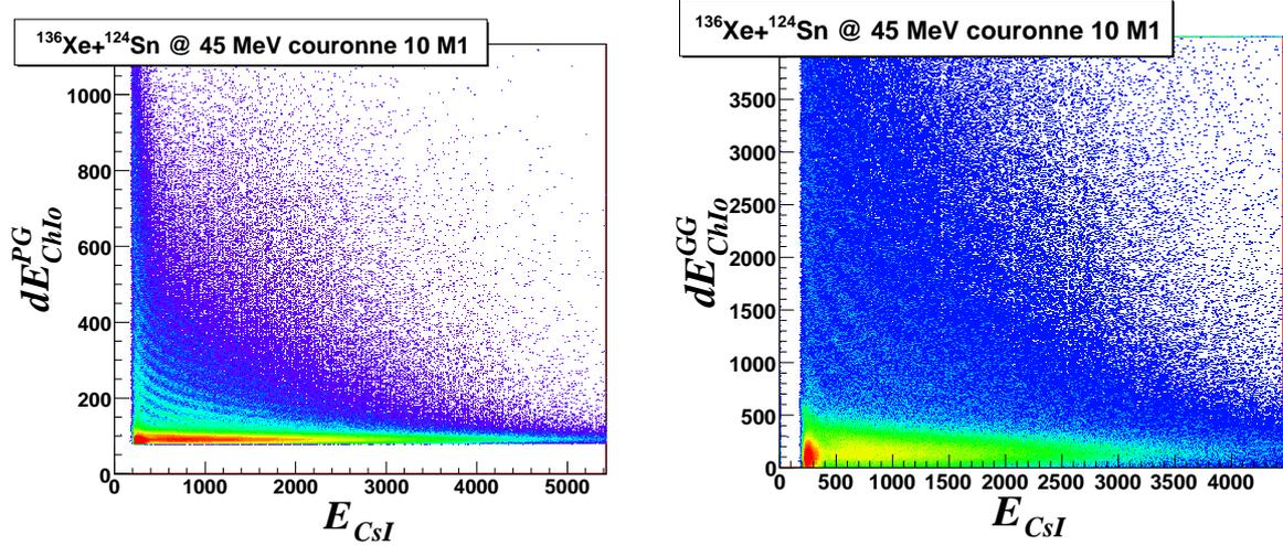
FIG. 3.8 – Exemple de matrice d'identification ChIo-CsI, pour les collisions  $^{136}\text{Xe} + ^{124}\text{Sn}@45\text{MeV}/A$  et le module 1 de la couronne 10 ( $\theta = 45 - 57^\circ$ ). À gauche pour le petit gain d'amplification du signal de la chambre d'ionisation (PG) et à droite pour le grand gain d'amplification de la chambre d'ionisation (GG).
