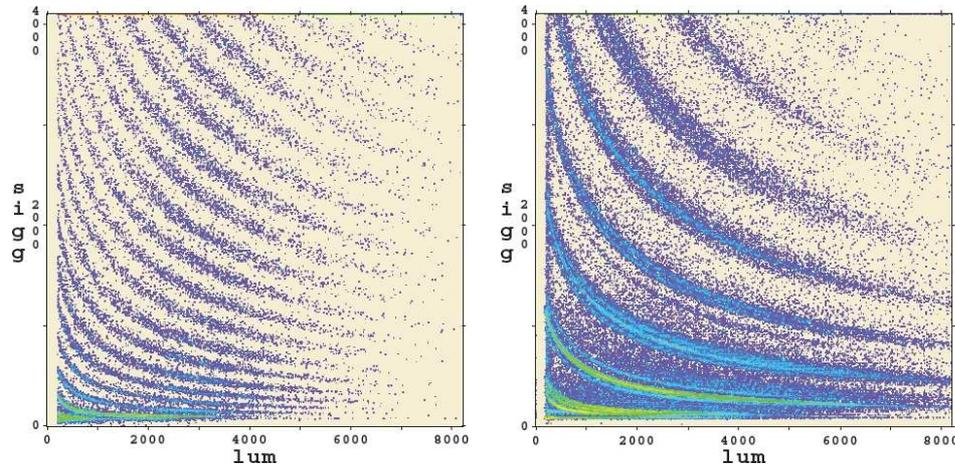
FIG. 3.9 – À gauche : matrice d'identification Energie Si-lumière CsI, pour un silicium 300  $\mu\text{m}$ . À droite : matrice d'identification Energie Si-lumière CsI, pour un silicium 150  $\mu\text{m}$ .
