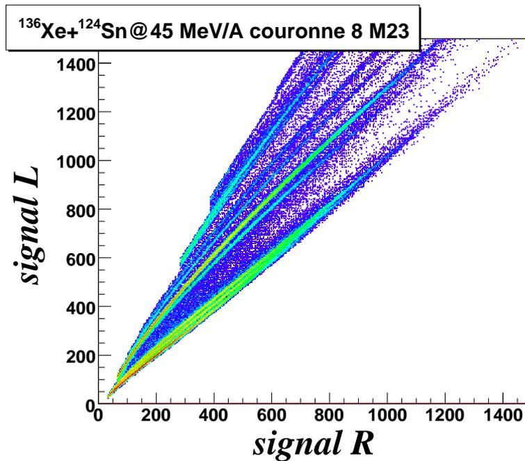
FIG. 3.7 – Matrice d'identification CsI rapide - CsI lent pour le système  $^{136}\text{Xe} + ^{124}\text{Sn}@45\text{MeV}/A$  et pour le module 23 de la couronne 8 (la ligne "neutre" a été ici retirée ainsi que les zones ne permettant pas l'identification en charge et/ou en masse).
