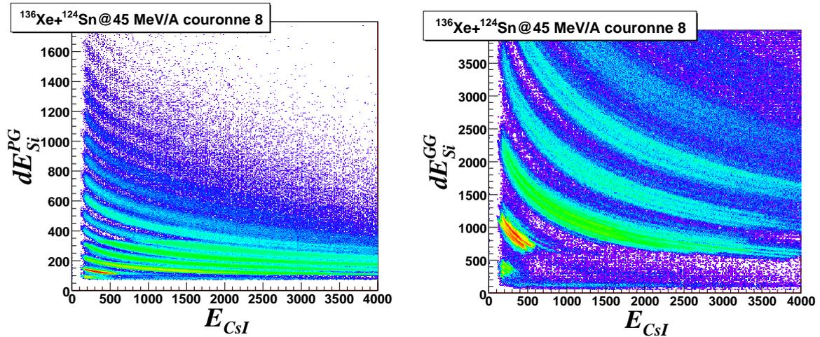
FIG. 3.6 – Matrice d'identification Si-CsI pour les collisions  $^{136}\text{Xe} + ^{124}\text{Sn}@45\text{MeV}/A$ . À gauche, matrice d'identification petit gain PG du signal silicium pour la couronne 8 (hors module  $150\ \mu\text{m}$ ), et à droite, matrice d'identification grand gain GG pour la couronne 8.
