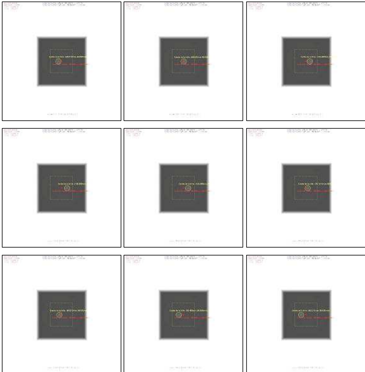
Figure 5.22. OTN représentant les images portales de la bille pour 9 angles du statif ( 0^\circ , 40^\circ , 80^\circ , 120^\circ , 160^\circ , 200^\circ , 240^\circ , 280^\circ et 320^\circ ). La bille est décalée de 3 mm sur l'axe gauche-droite et de 4 mm sur l'axe bas-haut.
