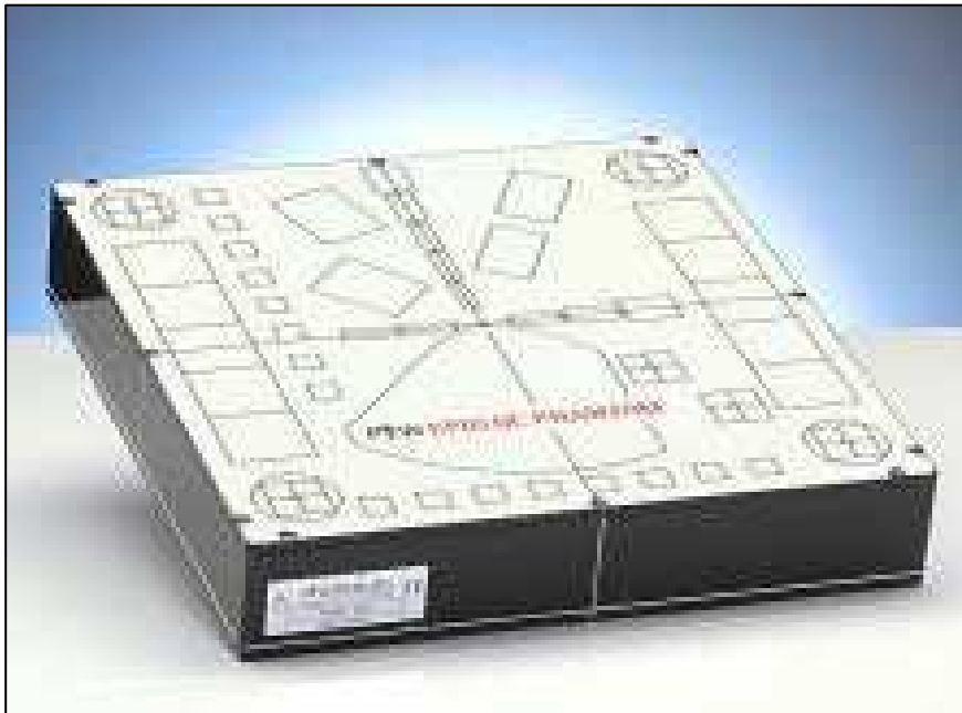
Figure 1.3. L'objet-test EPID-PTW utilisé pour le contrôle de qualité de l'image de l'EPID.
