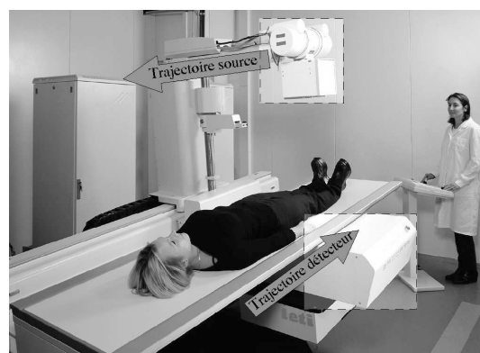
FIG. 1.24 – Vue d'ensemble du système d'acquisition table BACCARA + capteur PALADIO [12].
