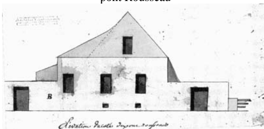
Figure A.11 : Maison sur le pont Rousseau 1777 [LELIEVRE 1988, p.257] : Taux d'ouverture : 18%
