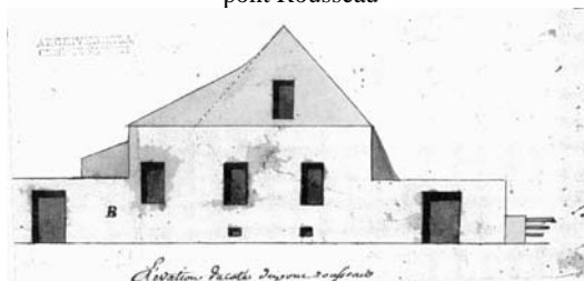
Figure A.11 : Maison sur le pont Rousseau 1777 [LELIEVRE 1988, p.257] : Taux d'ouverture : 18%
