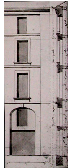
Figure A.17 : Façade rue St Clément établie par l'architecte Marmayou en 1779 et extrait d'un module de façade et son profil [AMN, 5Fi 52] Taux d'ouverture : 25,72%
