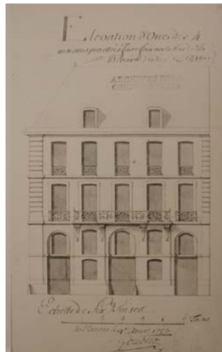
Figure A.14 : Façade d'un bâtiment de l'île Feydeau établie par Goubert en 1723 et extrait d'un module de façade [AMN, 5Fi 61] Taux d'ouverture : 34,80%
