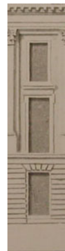
Figure A.16 : Façade du bâtiment de la place d'armes établi par Ceineray en 1773 et extrait d'un module de façade [AMN, 5Fi 59] Taux d'ouverture : 17,26%
