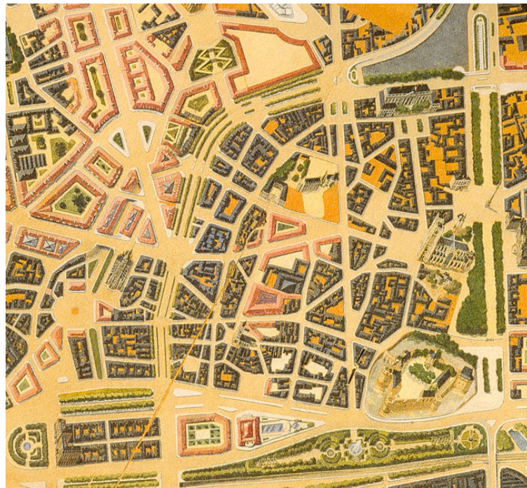
Figure 3.62 : Extrait du plan de reconstruction et d'aménagement de 1945 103 (en gris ce qui est à conserver, en marron à reconstruire)
