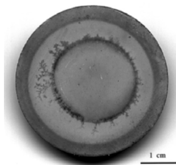
Figure 1.16. Cible de CuBr après une heure de pulvérisation magnétron (diamètre de la cible : 40 mm ; pression Ar : 3 Pa ; tension d'autopolarisation : - 600 V) (publication n° 14).
