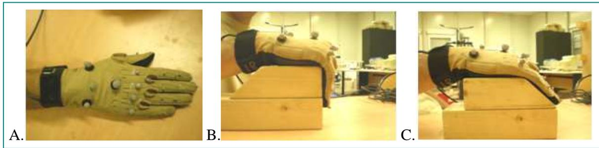
**Figure III.8 :** Postures de calibrage du Cyberglove (A : main à plat, B : MCP à 90°, C : MCP à 45°).
