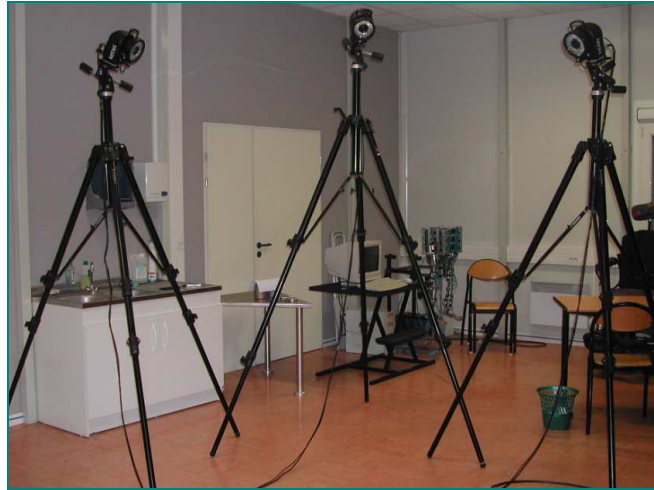
Figure III.9 : Photographie des caméras du système Vicon positionnées face à la zone de saisie.
