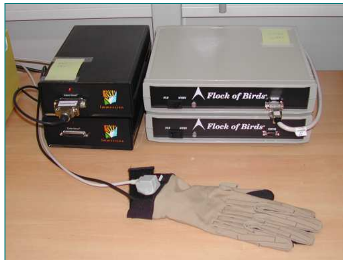
Figure III.6 : Photographie du Cyberglove et du capteur Flock of Bird.
