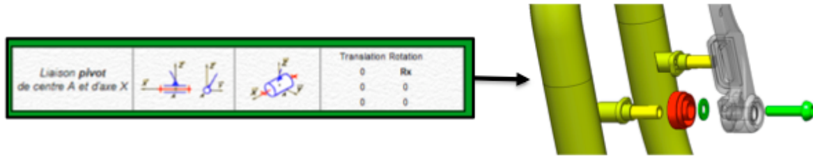
Figure 3.C4 : Conception d'une Liaison Pivot
