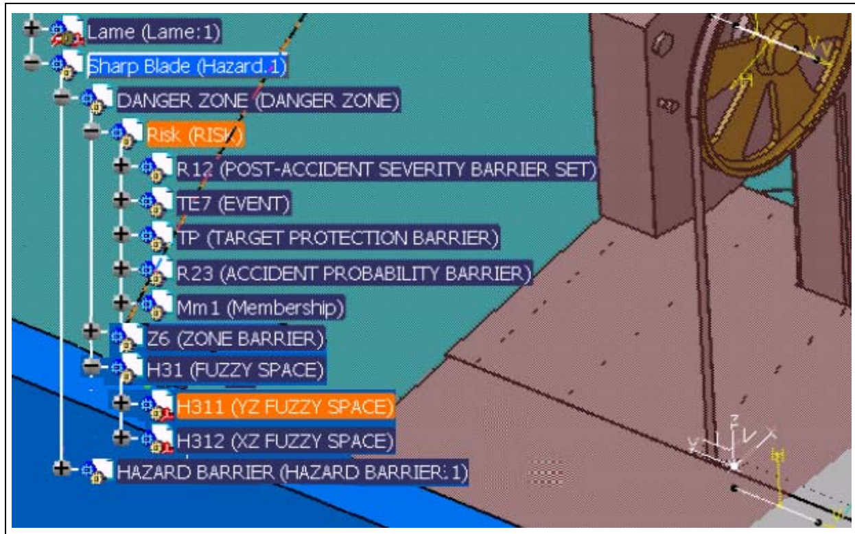
Figure 53. Une structure de l'entité de HAZARD, pour la scie à ruban, avant modification
