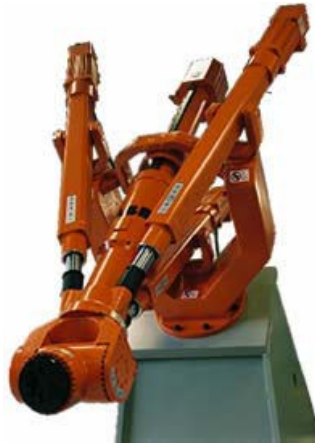
Figure 7 : Exemple de mécanisme hybride, le Tricept [SMT]
