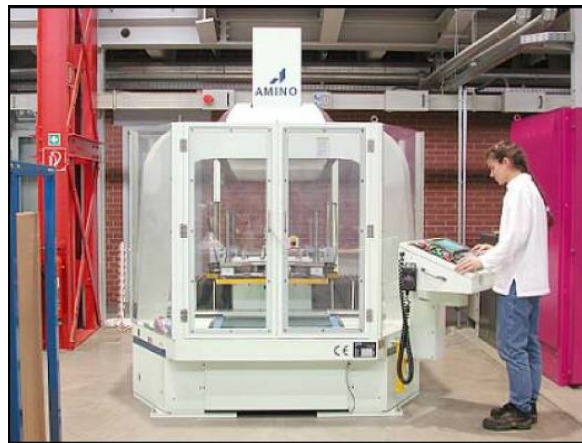
Figure 59 : Machine AMINO dédiée au formage incrémental [Jeswiet2005b]
