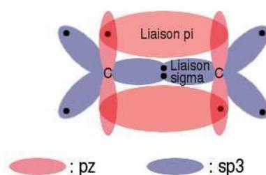
FIG. 1.6 – Structure orbitale de la double liaison  $C=C$ .
