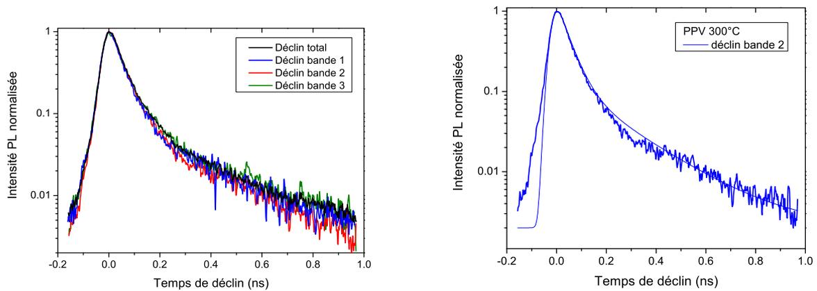
FIG. 3.11 – A gauche : déclin pour les trois bandes d’émission du film de PPV converti à 300°C,  $\lambda_{exc} = 400nm$ . A droite : simulation du déclin de la bande située à 555 nm du film de PPV converti à 300°C à l’aide de deux exponentielles non couplées convoluées au pulse laser.
