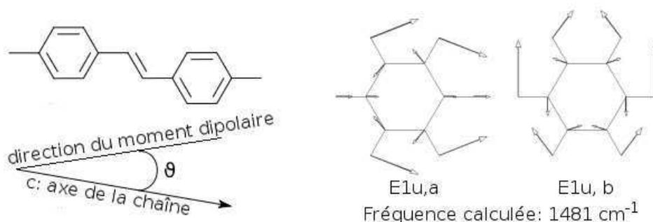
FIG. 4.20 – A gauche : représentation de l'angle  $\theta$  formé entre l'axe de la chaîne et le moment dipolaire ; à droite : représentation du mode de vibration dégénéré  $E_{1u}$  (calcul effectué par J.-Y. Mevellec et J.-P. Buisson).
