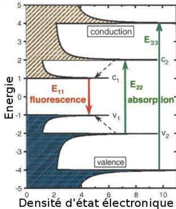
FIG. 4.31 – Schéma du processus de photoluminescence dans la densité d'état d'un SWCNT isolé [213].
