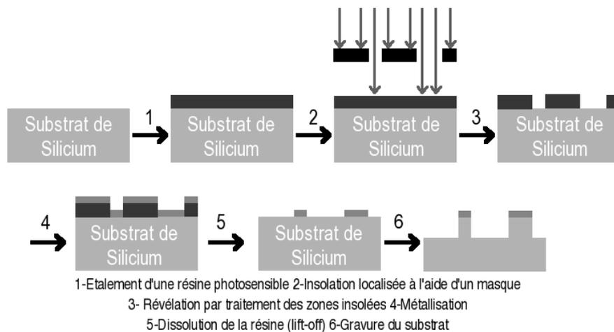
FIG. 1.2 – Déroulement typique d'un procédé de fabrication top-down.
