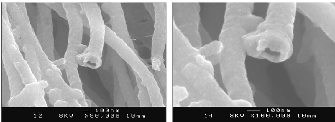
FIG. 2.39 – Paquets de nanofils synthétisés dans une membrane de PC 200 nm avec une solution composite PPV/SWCNT synthétisés par arc électrique avec  $P_{mass} = 16\%$ . A gauche : vue d'ensemble ; à droite : agrandissement sur un nanotube avec des parois épaisses.
