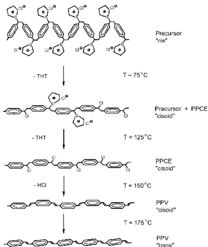
FIG. 2.4 – A 75°C, les premiers groupements THT du précurseur sous sa forme *cis* sont substitués par un mécanisme  $S_N2$  par du Cl. La chaîne qui a adopté la configuration cisoïde évacue les derniers groupements THT à 125°C. A 150°C, le Cl est évacué sous forme de gaz HCl. La température de 175°C permet d'optimiser l'isomérisation *trans*.
