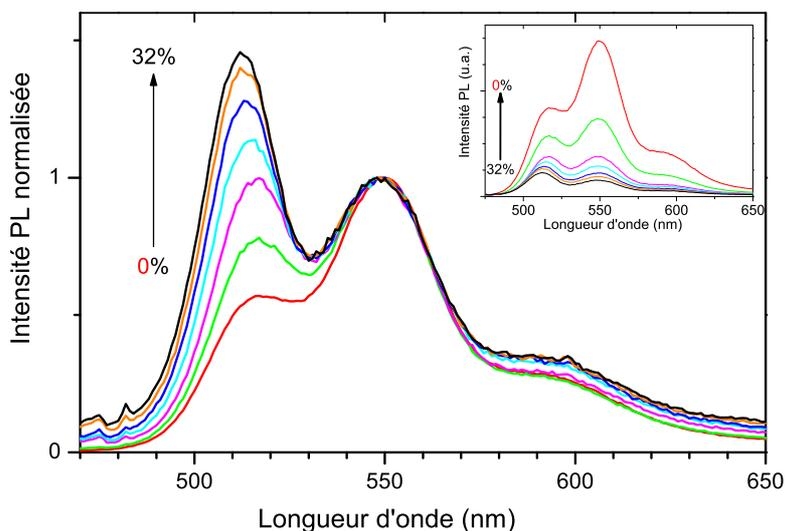
FIG. 3.7 – Spectres de PL pour les films composites PPV/SWCNT en fonction de  $P_{mass}$ , normalisation de l'intensité sur la seconde bande d'émission,  $\lambda_{exc} = 400nm$ . L'encart présente les mêmes spectres non normalisés.
