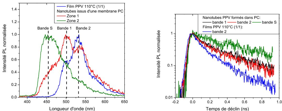
FIG. 4.15 – A gauche : spectres de PL des nanotubes de PPV (issus de dilution (1/20) du précurseur) obtenus en deux zones distinctes de l'échantillon et spectres du film de PPV 110°C issu d'une dilution (1/1). A droite : Déclins de PL des nanotubes de PPV sur les deux zones et du film pour différentes bandes d'émission. Les nanotubes sont élaborés dans les membranes PC 200 nm ;  $\lambda_{exc}=400$  nm.
