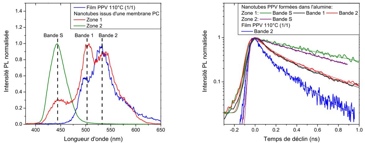
FIG. 4.16 – A gauche : spectres de PL des nanotubes de PPV (issus de dilution (1/20) du précurseur) obtenus en deux zones distinctes de l'échantillon et spectres du film de PPV 110°C issu d'une dilution (1/1). A droite : Déclins de PL des nanotubes de PPV sur les deux zones et du film pour différentes bandes d'émission. Les nanotubes sont élaborés dans les membranes d'alumine;  $\lambda_{exc}=400$  nm.
