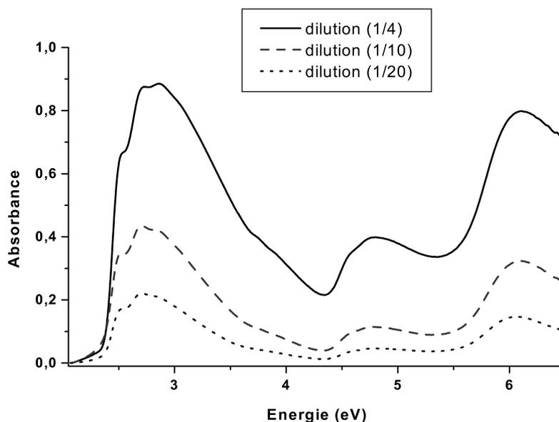
FIG. 3.3 – Spectres d'absorption optique de trois films de PPV issus de trois dilutions du précurseur différentes.
