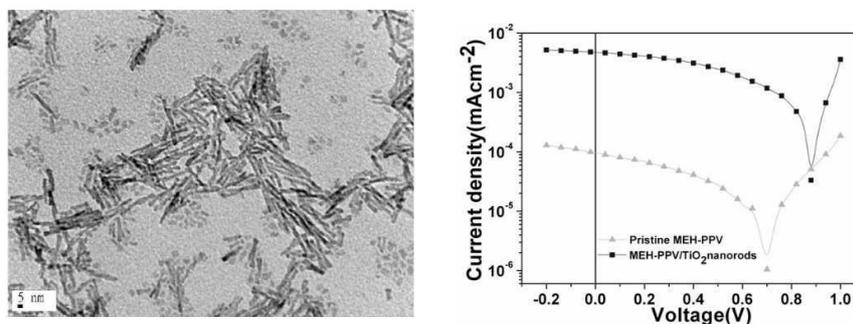
FIG. 1.28 – A gauche : image TEM des nanopiliers de  $TiO_2$ ; à droite : caractéristiques courant-tension des systèmes MEH-PPV avec 54% en masse de nanopiliers et sans nanopiliers sous une excitation de 450 nm. Une augmentation de deux ordres de grandeurs est obtenue à 0 V [118].
