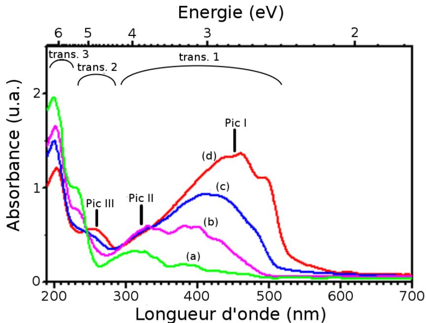
FIG. 3.1 – Spectres d'absorption optique du précurseur (a) et du PPV converti à : (b) 110°C, (c) 180°C, (d) 300°C.
