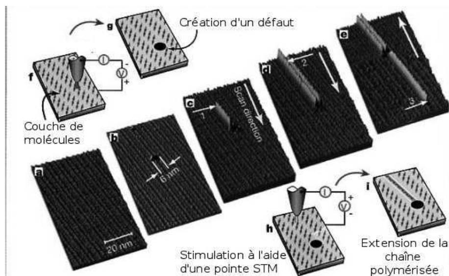
FIG. 1.18 – (a) couche monomoléculaire d'acide 10,12-nonacosadiynoic, (b) création d'un défaut, (c) première chaîne polymérisée, initialisée au point indiqué par la flèche (1) en utilisant la pointe du STM, (d) seconde chaîne polymérisée, (e) troisième chaîne polymérisée.
