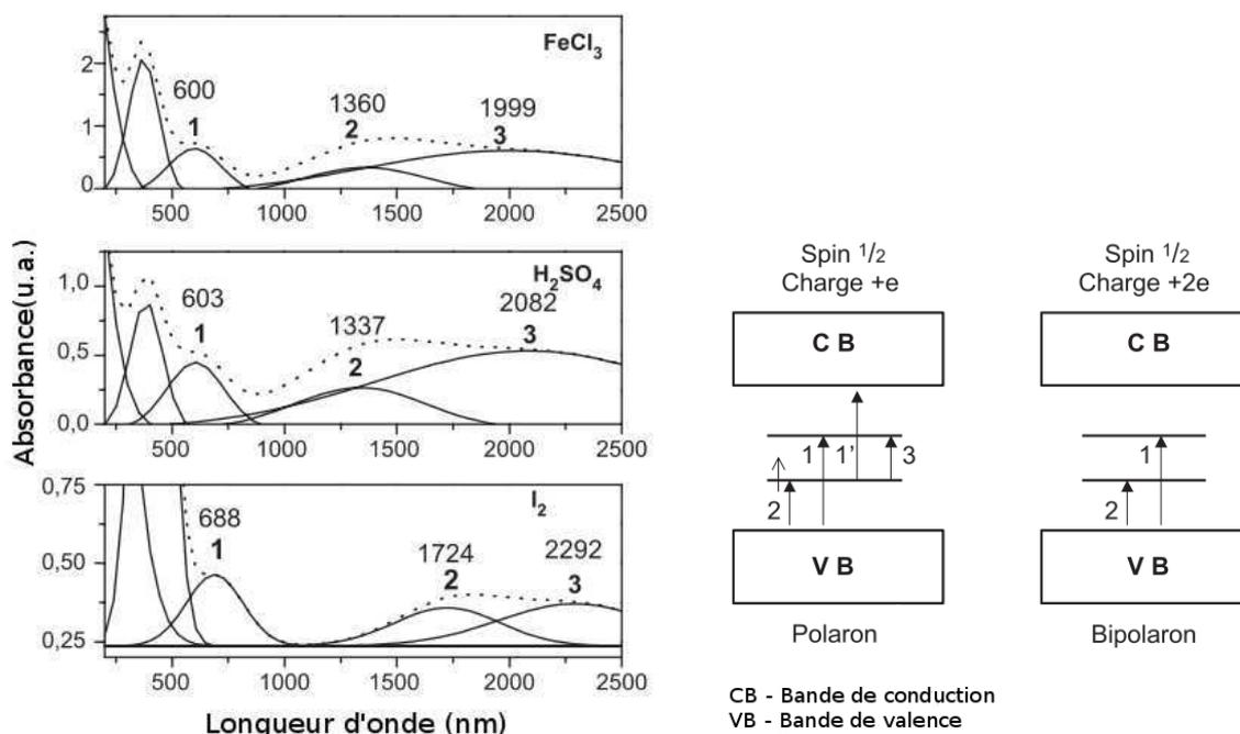
FIG. 4.4 – A gauche : spectres d'absorption optique et leurs pics de déconvolution pour des films de PPV dopés avec :  $I_2$  sous forme de vapeur (en bas); 0,12 M  $FeCl_3$  dans du nitrométhane (au milieu) et  $H_2SO_4$  concentré (en haut). Les bandes polaroniques et bipolaroniques sont indiquées par les chiffres 1, 2 et 3. A droite : représentation schématique des transitions optiques dues aux espèces polaroniques et bipolaroniques (les transitions 1 et 1' ont la même énergie [217]).
