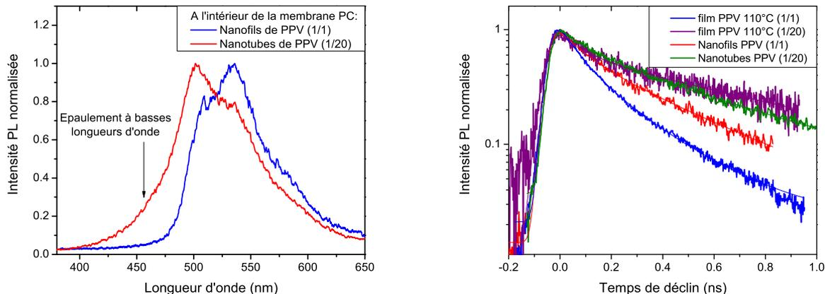
FIG. 4.13 – A gauche : spectres de PL de nanofils de PPV (issus de dilution (1/1) du précurseur) et de nanotubes de PPV (issus de dilution (1/20) du précurseur). A droite : Déclinés de PL des nanofils et des nanotubes de PPV. Les nanofibres sont étudiées dans la membrane PC. Les déclinés de film de PPV convertis à  $110^\circ\text{C}$  issus de dilutions (1/1) et (1/20) sont également ajoutés pour comparaison ;  $\lambda_{exc}=267$  nm.
