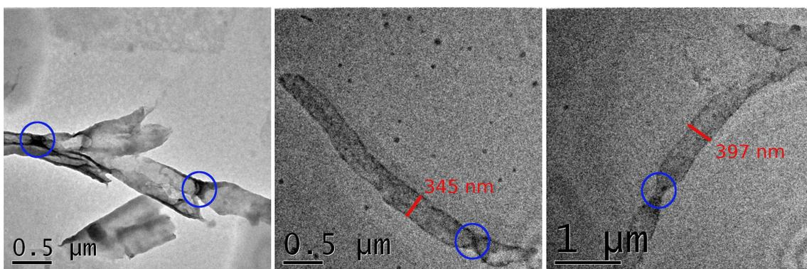
FIG. 2.30 – De gauche à droite : nanotubes de PPV.
