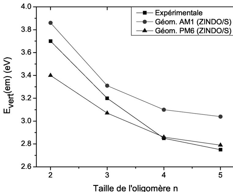
FIG. 5.3 – Transitions verticales d'émission  $E_{vert}(em)$  obtenues par deux méthodes semi-empiriques : AM1/ZINDO/S [237] et PM6/ZINDO/S comparées aux valeurs expérimentales [237] pour différents oligomères du PPV.
