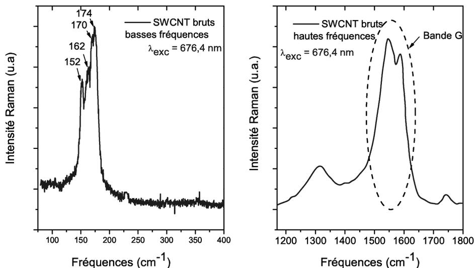
FIG. 3.25 – Spectre Raman obtenu pour les SWCNT synthétisés par la méthode arc électrique avec  $\lambda_{exc}=676$  nm. La partie de gauche présente le domaine basses fréquences, la partie de droite le domaine hautes fréquences.
