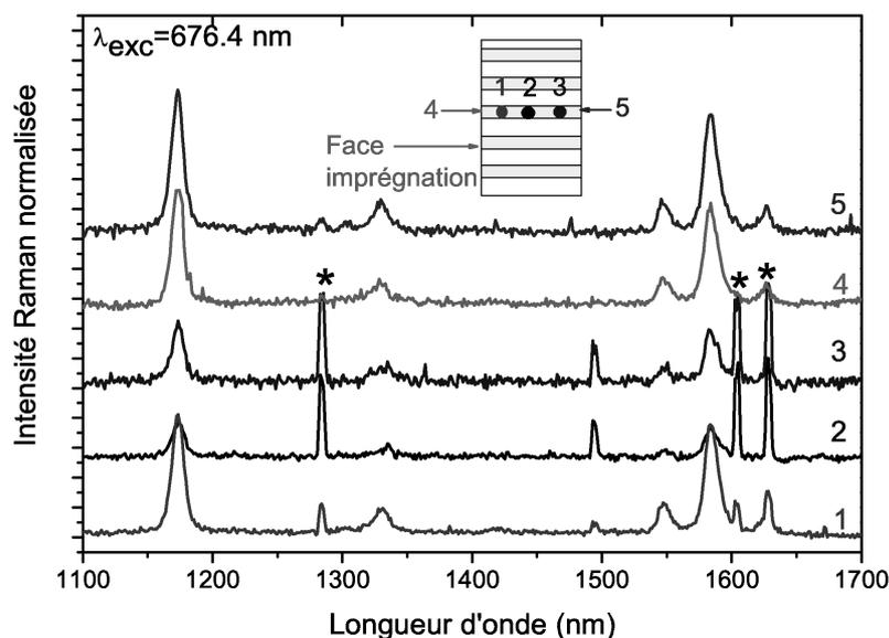
FIG. 4.22 – Spectres de diffusion Raman réalisés en différents points d'une membrane d'alumine contenant du PPV issu d'une dilution (1/1) converti à  $300^\circ\text{C}$ ,  $\lambda_{exc} = 676,4 \text{ nm}$ . Le schéma en haut indique les zones où sont réalisés les spectres, numérotées de 1 à 5. Les raies indiquées par une \* indiquent les raies parasites du laser d'excitation.
