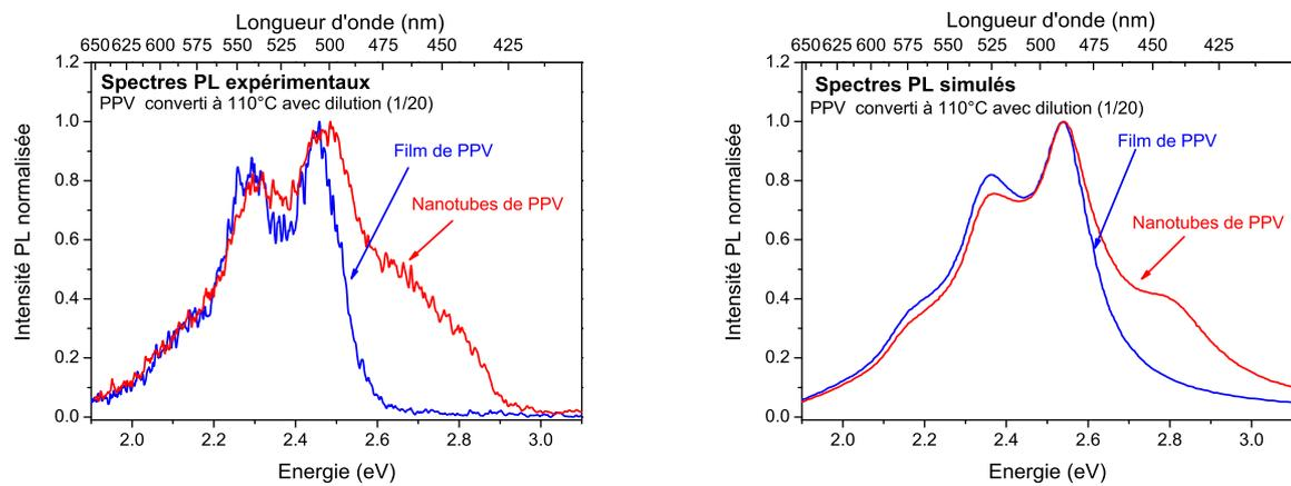
FIG. 5.13 – Spectres de PL expérimentaux (à gauche) et simulés (à droite) d'un film de PPV converti à 110°C issu d'une dilution (1/20) et de nanotubes de PPV synthétisés dans des membranes PC par imprégnation d'une solution de précurseur de dilution (1/20) et convertis à 110°C.
