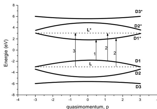
FIG. 3.2 – Structure de bandes du PPV [169]
