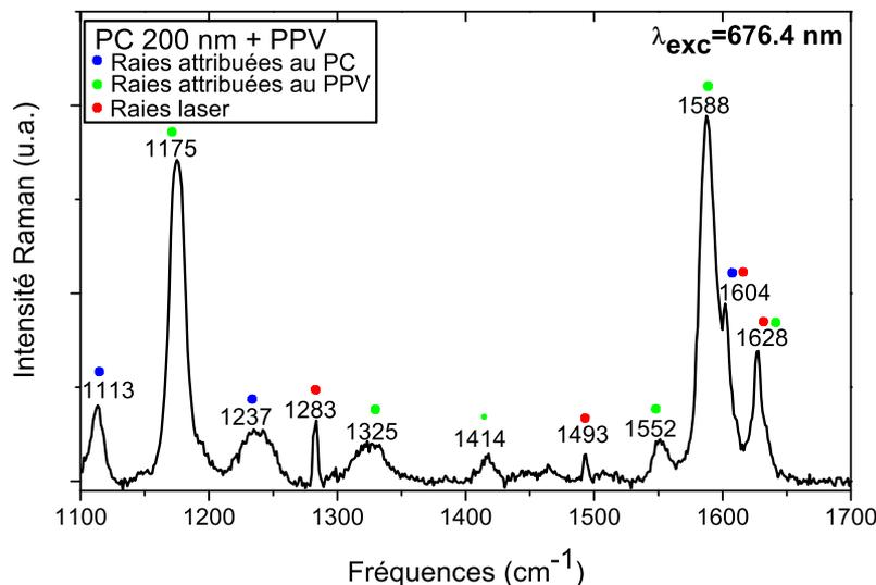
Fig. 4.24 – Spectre de diffusion Raman d’une membrane de PC de diamètre de pores 200 nm contenant du PPV issu d’une dilution (1/1) du précurseur. L’analyse est faite sur la face d’imprégnation,  $\lambda_{exc} = 676,4$  nm.
