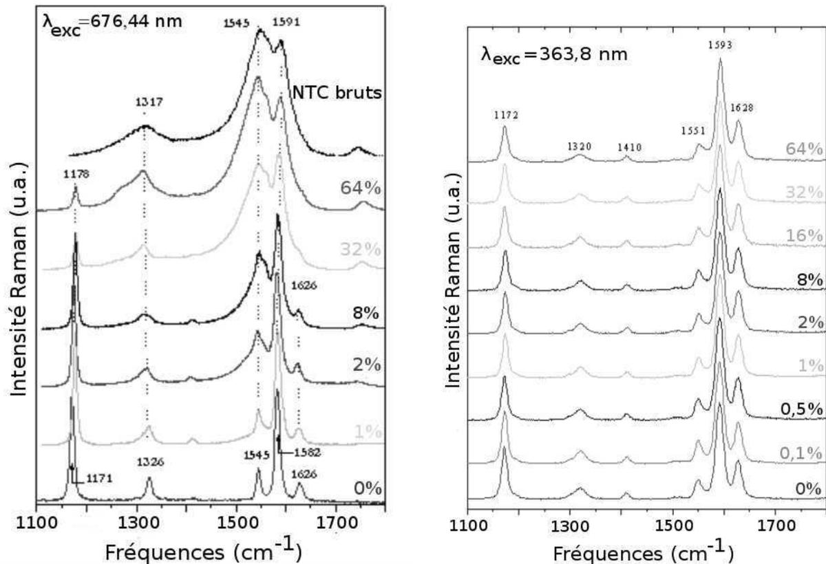
FIG. 3.27 – Spectres de diffusion Raman des composites PPV/SWCNT pour  $\lambda_{exc} = 676,4nm$  (à gauche) et pour  $\lambda_{exc} = 363,8nm$  (à droite).
