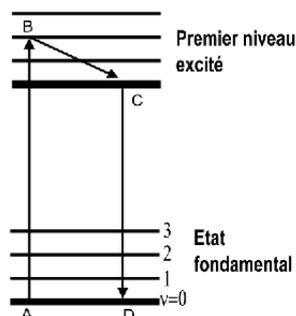
FIG. B.2 – Diagramme énergétique de la photoluminescence.
