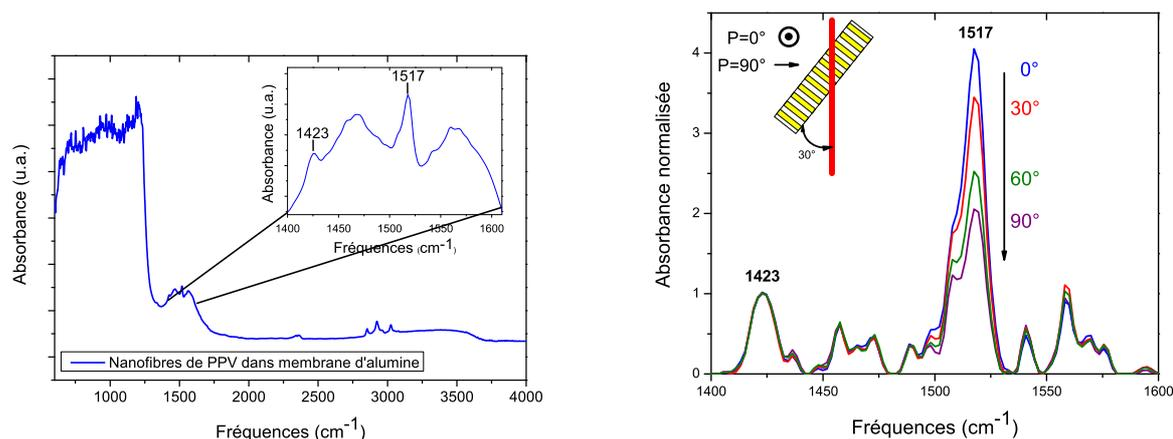
FIG. 4.19 – A gauche : spectre d'absorption IR de nanofibres de PPV incluses dans une membrane d'alumine issues d'une dilution (1/1) et converties à  $300^{\circ}\text{C}$ . A droite : étude d'absorption IR polarisée du même échantillon. Le schéma en insert précise la position de l'échantillon et la polarisation du faisceau incident.
