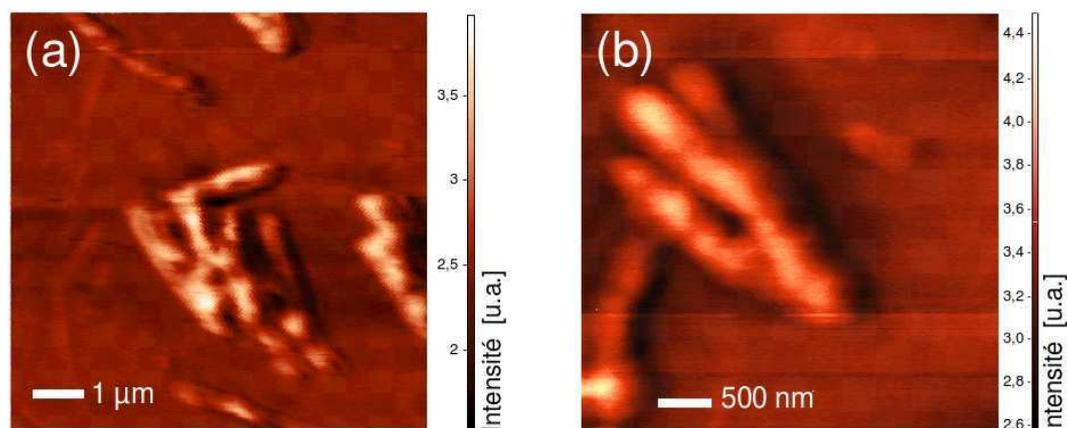
FIG. 2.36 – Images optiques SNOM de nanofibres de PPV.
