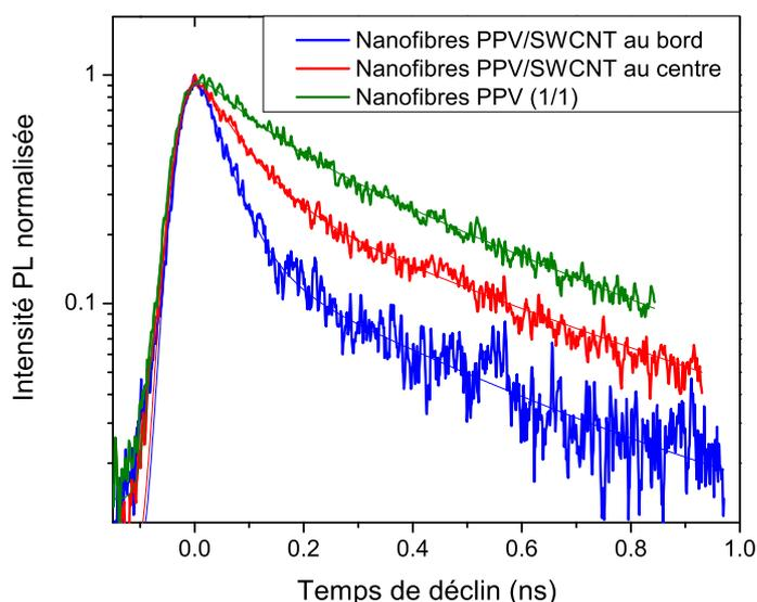
FIG. 4.17 – Déclinés de PL obtenus sur une membrane de PC contenant des nanofibres composites PPV/SWCNT-arc électrique avec  $P_{mass} = 16\%$  en différentes zones : au centre et au bord. Le déclin obtenu sur les nanofils de PPV étudiés dans la membrane de PC est également présenté pour comparaison ;  $\lambda_{exc} = 267$  nm.
