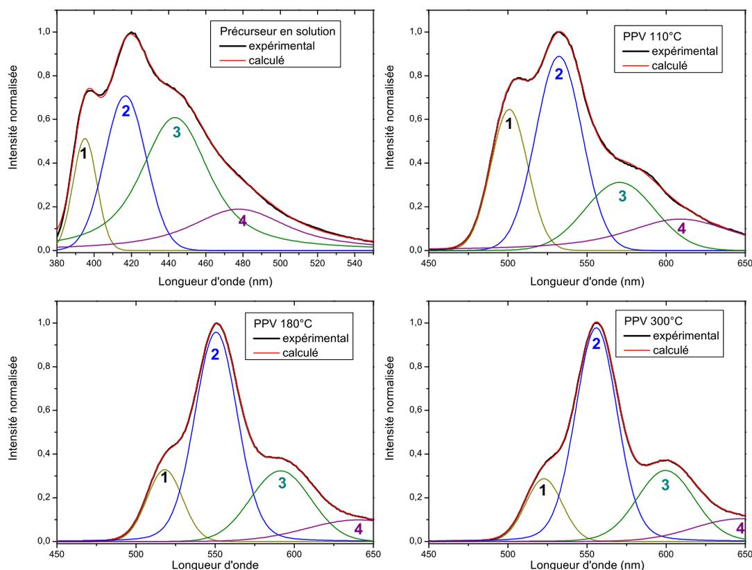
FIG. 3.5 – Déconvolutions des spectres de PPV en fonction de la température de conversion.
