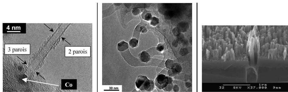
FIG. 1.3 – De gauche à droite : NTC double paroi avec la particule de catalyseur à sa base (procédé base growth) ; Nanofibres de carbone synthétisées à température ambiante ; NTC synthétisé au fond d'un canal.
