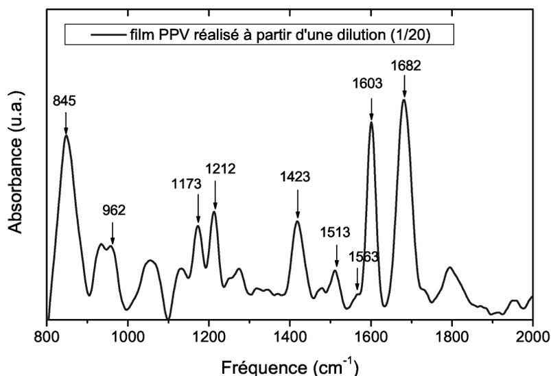
FIG. 3.17 – Spectre FTIR d'un film mince réalisé à partir d'une solution de précurseur fortement diluée (1/20) et converti à 300°C.
