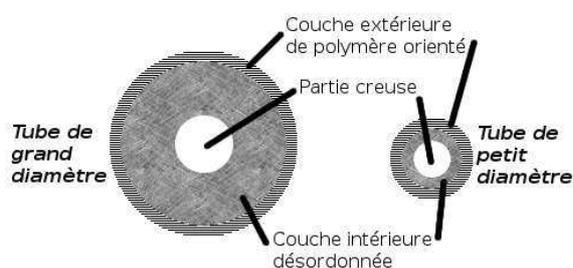
FIG. 1.23 – Synthèse de nanotubes de différents diamètres [101].
