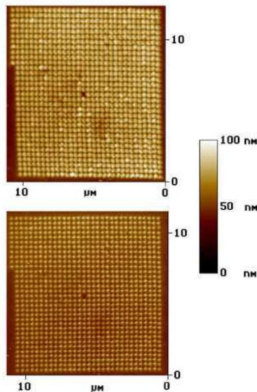
FIG. 1.34 – Images AFM en mode tapping d'un réseau régulier de PPV avec une périodicité de 330 nm lithographié par SNOM. L'image du haut montre le réseau de polymère précurseur du PPV structuré après dissolution du matériau non lithographié en excès par le méthanol. L'image du dessous montre le réseau après total conversion du polymère en PPV [137].
