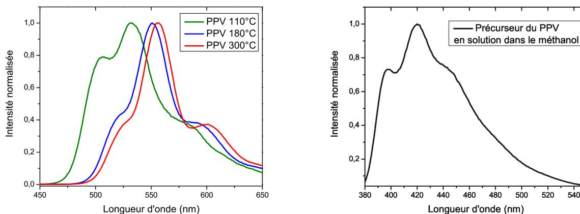
FIG. 3.4 – A gauche : spectres de photoluminescence du PPV en fonction de sa température de conversion,  $\lambda_{exc} = 440\text{nm}$ . A droite : spectre de photoluminescence du précurseur en solution,  $\lambda_{exc} = 360\text{nm}$ .
