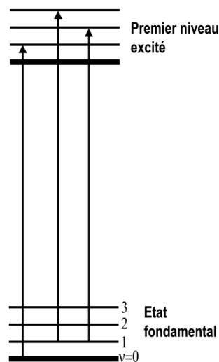
FIG. B.1 – Diagramme énergétique de l'absorption optique.
