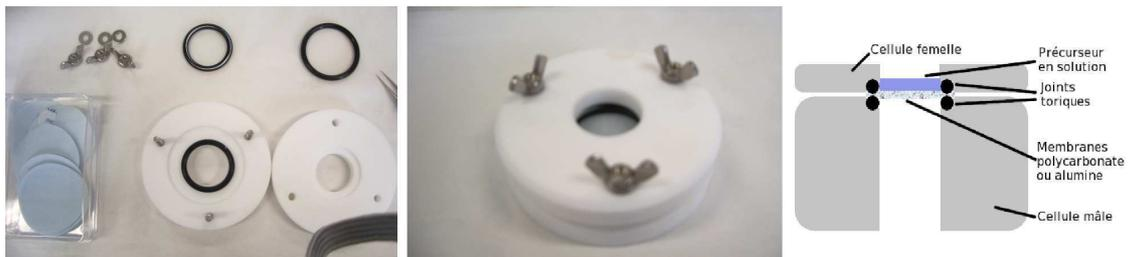
FIG. 2.8 – A gauche : cellule démontée ; au milieu : montage final avec membrane installée ; schéma en coupe.
