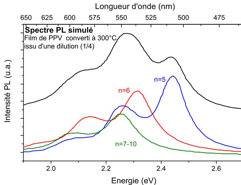
FIG. 5.10 – Simulation du spectre de PL d'un film de PPV converti à 300°C issu d'une dilution (1/4). Les spectres des oligomères  $n=5$  à 10 qui participent à la simulation du spectre sont présentés au dessous. Chaque spectre de PL d'oligomère a son intensité qui dépend de la pondération donnée par la distribution bimodale.
