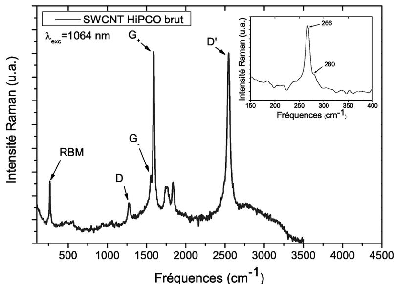
FIG. 4.29 – Spectre Raman obtenu pour les SWCNT synthétisés par la méthode HiPCO avec  $\lambda_{exc}=1064$  nm. L'encart présente un agrandissement de la partie aux basses fréquences.
