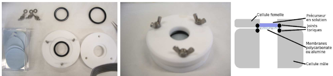
FIG. 2.8 – A gauche : cellule démontée ; au milieu : montage final avec membrane installée ; schéma en coupe.
