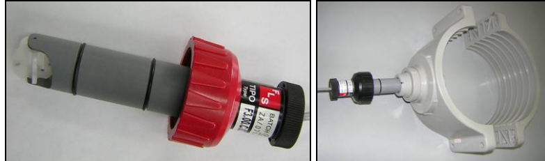
Figure 170. Le débitmètre et le collier de montage utilisés dans la source sous-marine S2.
