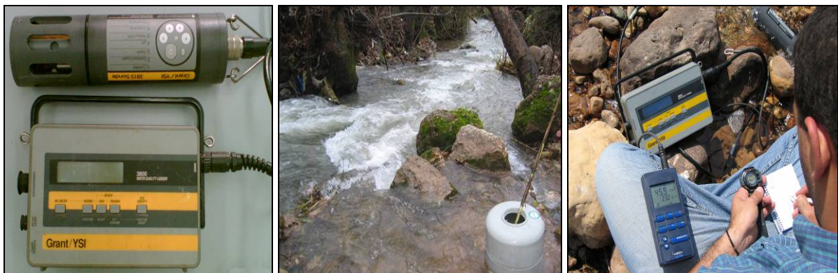
Les équipements et les étapes lors d'un jaugeage chimique.
