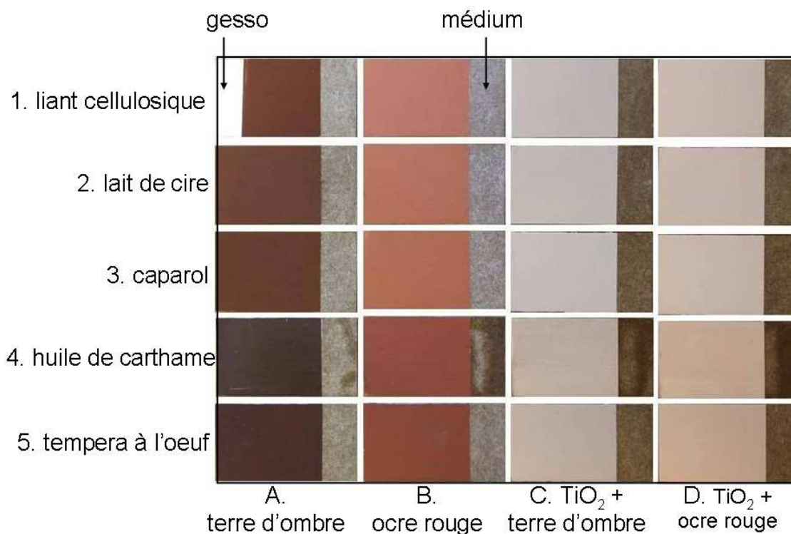
FIG. 2.2 – Échantillons préparés à partir des 5 liants et de 2 pigments seuls ou 2 mélanges pigmentaires.
