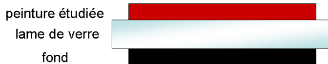
FIG. 2.17 – Schéma des échantillons nécessaires à la détermination des propriétés optiques ( k et s ) des couches picturales.
