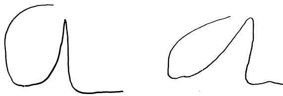
FIG. 6.33 – Trace écrite par le robot holonome reproduisant le style d'écriture du scripteur Estelle à gauche et du scripteur Christophe à droite.
