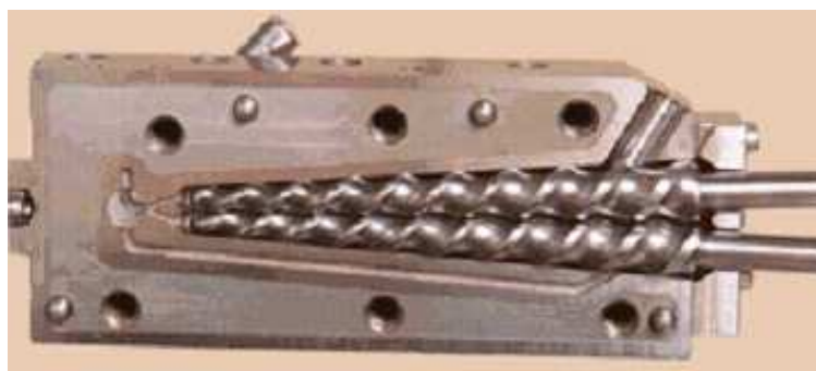
FIG. A.1: Micro-extrudeuse DACA utilisée pour les extrusions réactives.
