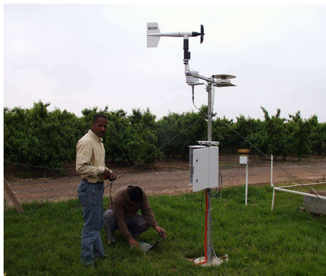
Figure II.24: Exemple de station météorologique SudMed installée dans le secteur irrigué NFIS.
