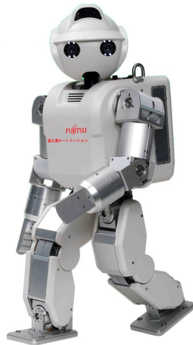
FIG. 3.19 – Le robot humanoïde HOAP-3 a servi de plate-forme de test et de validation.
