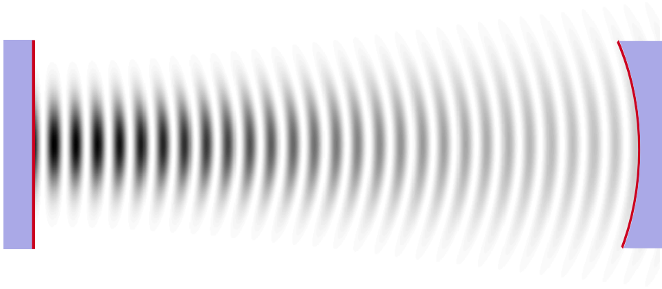
Figure 2.3: Profils transverse et longitudinal à deux dimensions du premier mode gaussien résonant à l'intérieur d'une cavité plan-concave quelconque. Le rayon de courbure du mode doit épouser la forme des miroirs, ce qui définit la taille et la position du waist dans la cavité.
