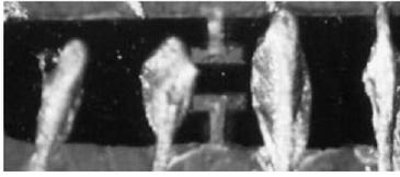
Figure 17 : Micropont monocristallin ( $200 \times 400 \mu\text{m}^2$ ) de Bi-2212 ( $T_c=79.5 \text{ K}$ ) ainsi que les contacts fils d'Or et laque d'Ag.
