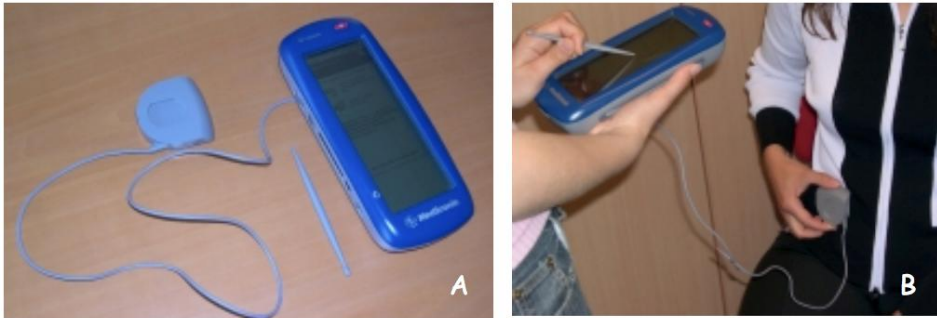
Figure 30. Le système de stimulation est un circuit ouvert programmé par télémétrie à l'aide d'une console de programmation, la N-Vision.
