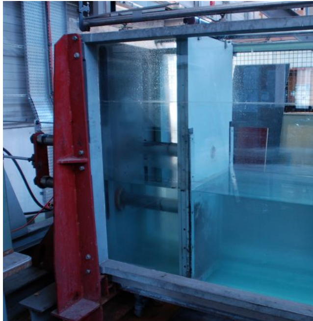
FIGURE 2.3 – Photo du générateur de vagues.
