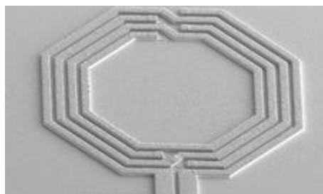
Figure 1-11: Exemple d'inductance réalisée sur PICS
