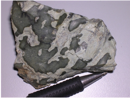
Figure 1. 9: Péridotites de la séquence de Vavouto affectées a) par l'altération de type « Vavouto » en doigts de gants caractérisée par l'imbrication de zones claires et de zones sombres.
