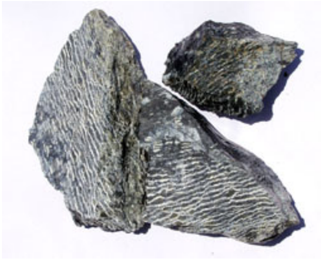
Figure 2.7: Sous-faciès de péridotite à texture zébrée caractérisé par le développement de nombreuses veinules subparallèles de chrysotile dont l'épaisseur varie de 1 à 5 mm au sein d'une matrice serpentinisée noirâtre.
