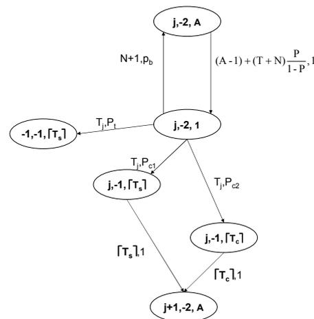
FIG. 2.21 – le modèle d'une tentative d'accès
