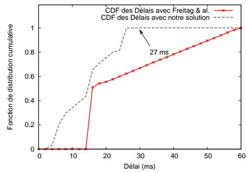
FIG. 4.11 – Délais d'UGS et rtPS FS=20ms
