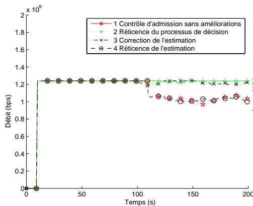
FIG. 3.9 – Débit moyen des flux , scénario 3
