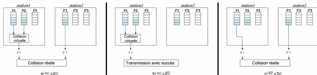
FIG. 2.25 – Différents scénarios de collisions : a)  $VC \circ RC$ ; b)  $VC \circ \overline{RC}$ ; c)  $\overline{VC} \circ RC$
