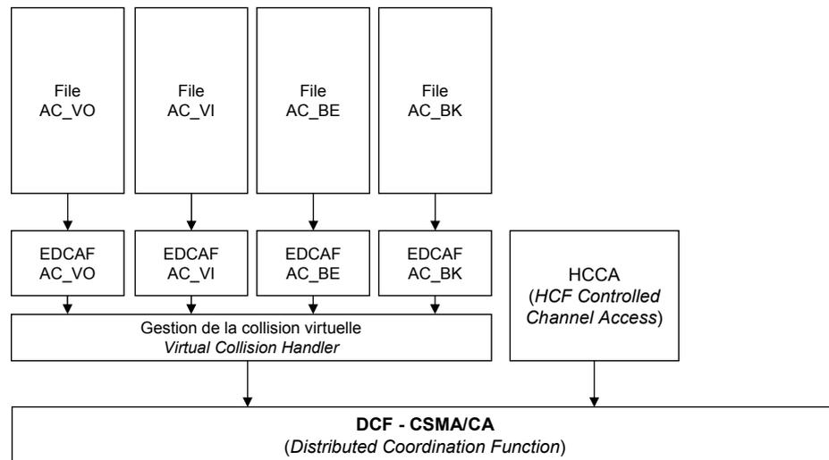
FIG. 1.3 – Schéma d'une station avec EDCA.
