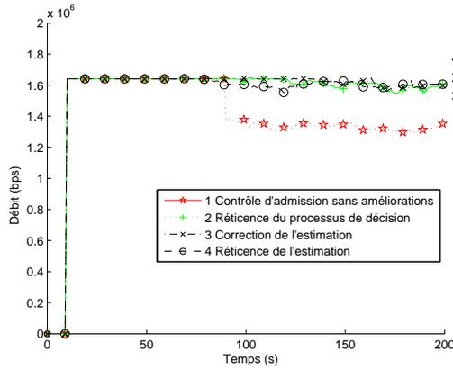
FIG. 3.7 – Débit moyen des flux , scénario 3
