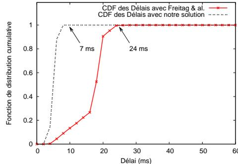
FIG. 4.9 – Délais d'UGS et rtPS FS=5ms
