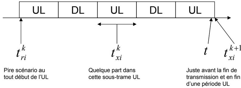
FIG. 4.6 – Différents instants de transmission et de requêtes
