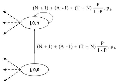
FIG. 2.18 – Bloc de backoff - Motif avec  $k = 0$  réduit
