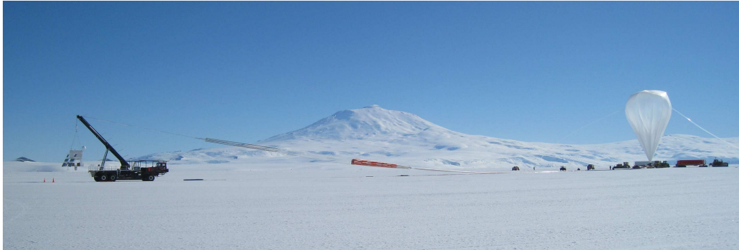
FIGURE 6.6 – CREAM-IV suspendu au bras du camion porteur immédiatement avant le lancement. Au détecteur sont attachés le parachute (en rouge) et le ballon qui est en cours de gonflage.
