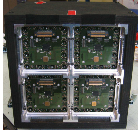
(b) Vue de derrière : le module, fixé sur un cadre métallique, est composé de quatre sous-modules dont chacun possède une carte d'électronique frontale pour la lecture des données.
