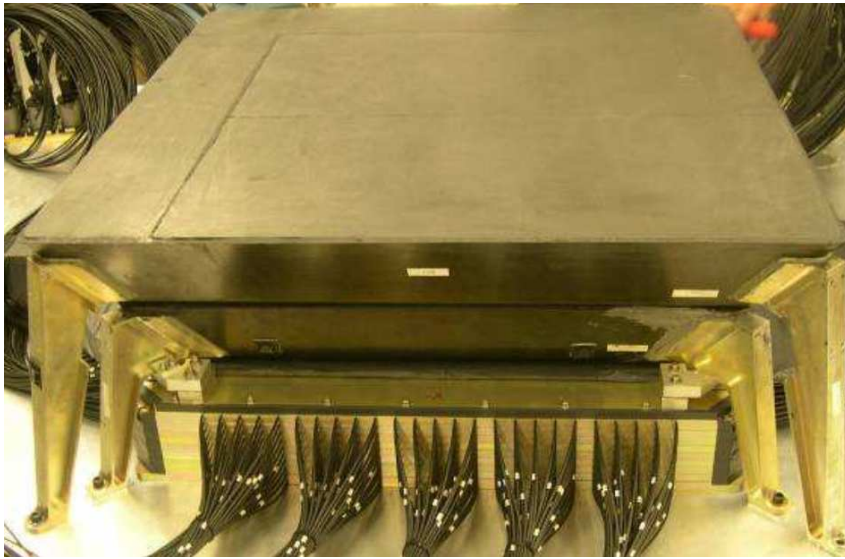
FIGURE 6.4 – Le calorimètre monté en-dessous de ses cibles en graphite.
