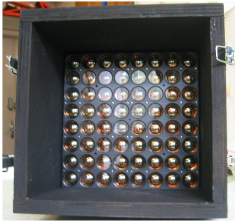
(a) Vue de face : le module de 64 photomultiplicateurs est fixé dans un boîtier en bois. Un appariement de deux tuiles d'aérogel est fixé sur le couvercle.
