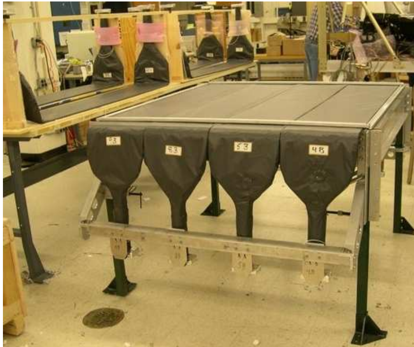
FIGURE 6.2 – Une couche de quatre palettes scintillateur en plastique protégés du TCD sur leur support. Les quatre autres palettes sont visibles en arrière plan dans leur structure de transport.
