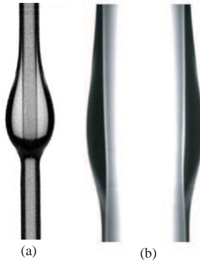
Fig. A.4. (a) Goutte type sphérique ( R=0.2\text{ mm} , H=0.25\text{ mm} , R/H=0.8 ). (b) Goutte type cylindrique ( R=1.5\text{ mm} , H=0.6\text{ mm} , R/H=2.5 ).
