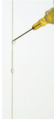
Fig. 6.5. Dispositif expérimental : on dépose, à l'aide d'une aiguille, une goutte de volume contrôlé sur une fibre verticale.
