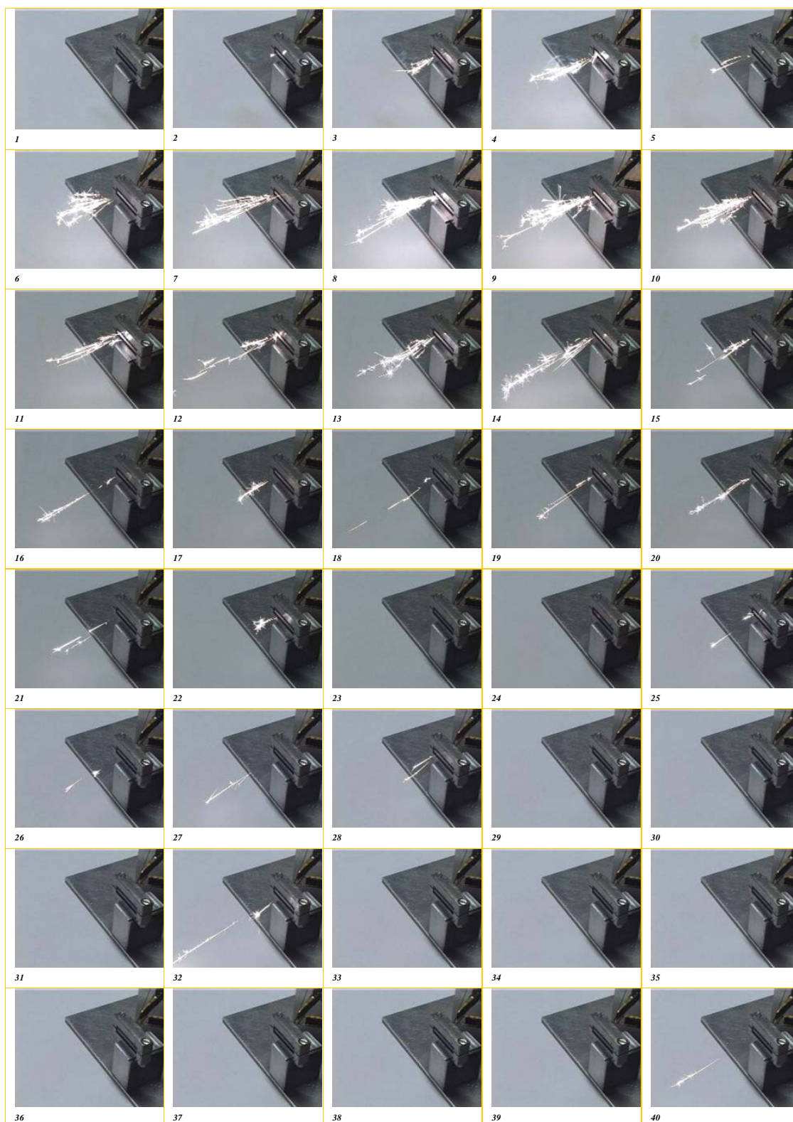
Figure 74 : Séquence de photos, intercalées de 40ms, prises durant la combustion de la composition DB+20%PN dans une structure de 150 \mu m de largeur de col (CLIP 14).
