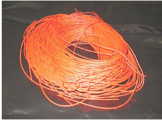
Figure 49 : Propergol DBE 40 320 à l'état final
