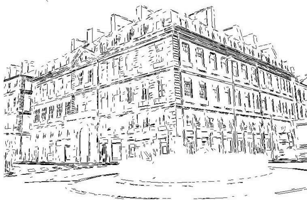
Fig. 5.7. Résultats de détection de segments un bâtiment à Nantes. 5800 segments ont été extraits.
