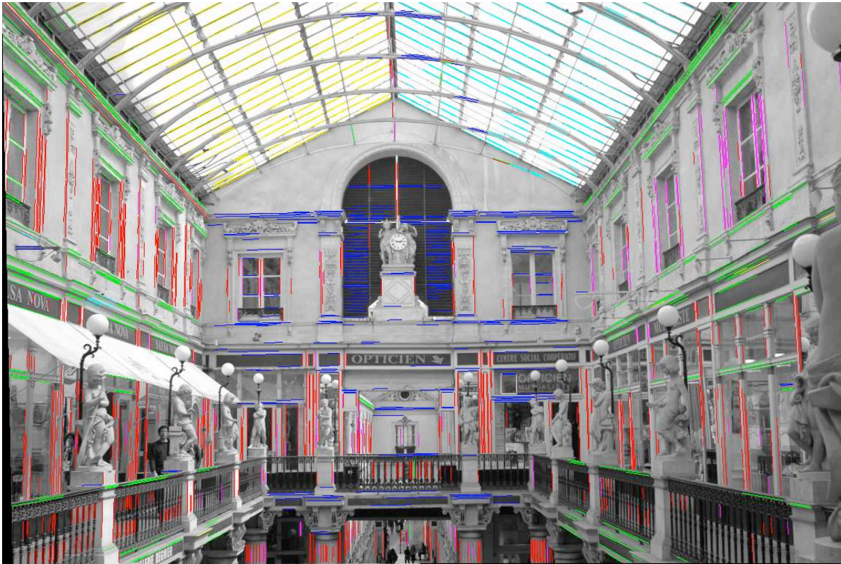
Fig. 4.4. Image du célèbre "Passage Pommeraye" à Nantes immortalisé par Jacques Denis dans un film. Cette scène comporte cinq points de fuite. Résultats de classification des différentes familles de segments correspondant aux familles de points de fuite. Deux familles de segments parallèles sont situées sur le toit en verre (en jaune et cyan).
