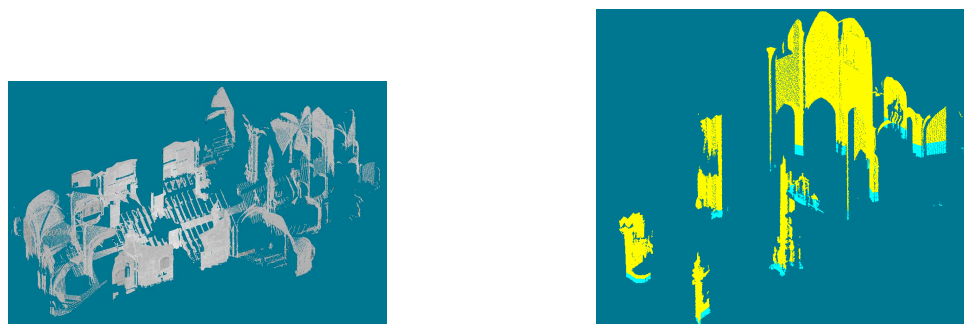
a) Nuage de points acquis de puis la première station. b) Nuage de points asquis depuis la deuxième station.
