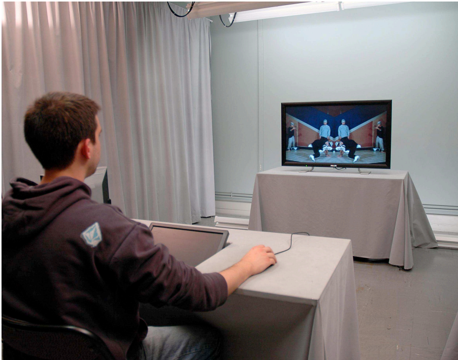
Fig. 1.7. Illustration de l'écran 3D WOW de Philips. Dans l'équipe Images Vidéo Communications de l'IRCCyN, cet écran est utilisé pour deux axes de recherches majeurs : la qualité d'expérience et l'étude de la fatigue visuelle. Pour la qualité d'expérience, les recherches se portent sur la définition de la notion de qualité pour les écrans 3D (différente de la 2D) et l'amélioration du rendu des différents écrans autostéréoscopiques. Pour la fatigue visuelle, l'équipe essaye de trouver et valider des protocoles afin de mesurer la fatigue visuelle engendrée par ces nouveaux médias.
