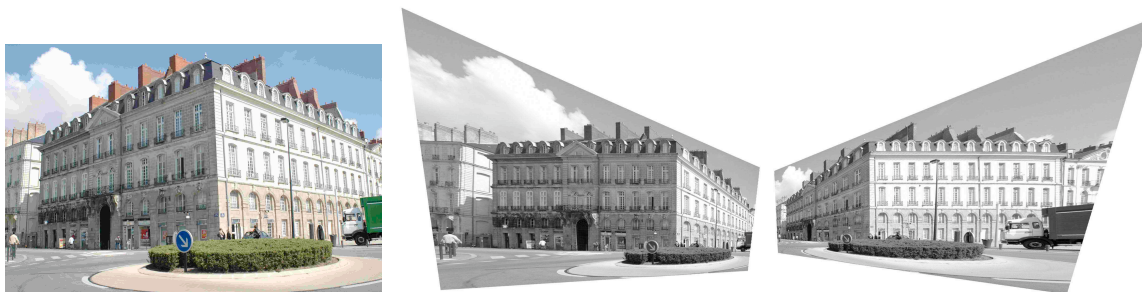
Fig. 4.13. Rectification d'image à l'aide des points de fuite détectés à l'aide des algorithmes présentés dans cette thèse (chapitres 5 et 6)
