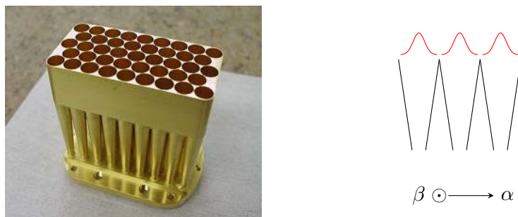
Figure 2.5 – Une des matrices de cornets à gauche et la représentation schématique d’une coupe transversale. La courbe en cloche rouge représente la réponse impulsionnelle des cornets h_c .
