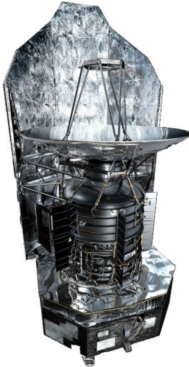
Figure 1.1 – Image synthétique du satellite Herschel. Le bouclier thermique est en arrière plan du miroir primaire et secondaire. Juste en dessous du miroir primaire se trouve le cryostat qui contient tous les instruments. Le bloc inférieur contient l'électronique ainsi que les instruments de mesure, de télémétrie, de traitement de données, etc. Il mesure plus de sept mètres de haut et pèse plus de trois tonnes.
