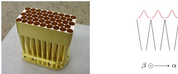
**Figure 2.5** – Une des matrices de cornets à gauche et la représentation schématique d’une coupe transversale. La courbe en cloche rouge représente la réponse impulsionnelle des cornets  $h_c$ .
