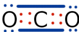
Fig. I3. Règle de l'octet. Les liaisons chimiques du CO_2 , molécule dans laquelle 8 électrons avoisinent chacun des atomes.
