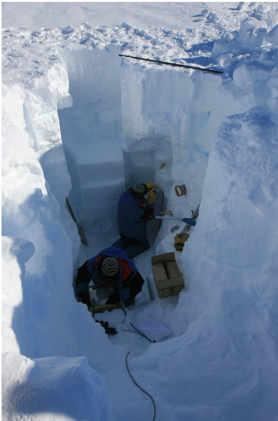
FIG. 4.2 – Photographie du puits de neige creusé à Dôme C durant la saison 2006-07 pour mesurer la densité et la réflectance IR. Photographie prise par L. Arnaud.
