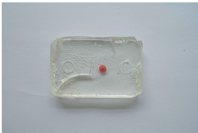
FIG. D.1 – Fantôme à base de Styrène contenant une cible de vermiculite contrastée par de l'éosine.
