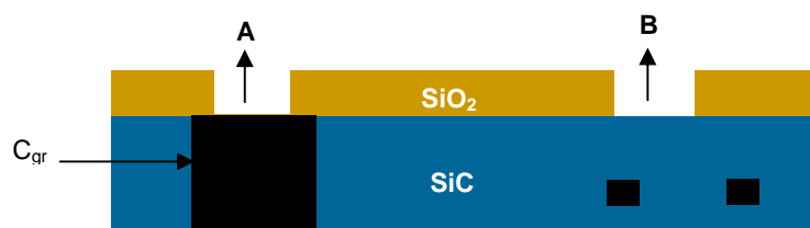
Figure 3.39. Les bulles mettent l'air en contact direct soit avec une particule de graphite (A), soit avec du SiC (B). Dans le premier cas, il y aura combustion du graphite tandis que dans l'autre la couche de silice se cicatrisera.
