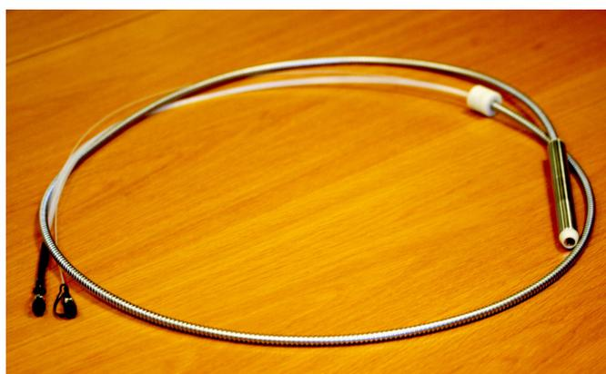
**Figure D.** Vue intégrale du stylo optique.
