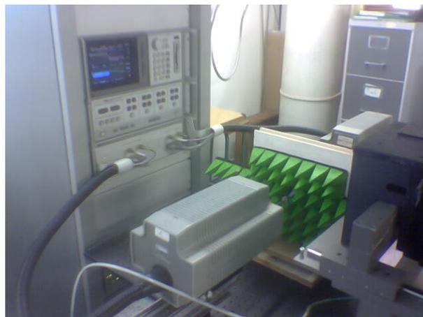
FIGURE 3.12 – Vue du banc de caractérisation mis en place à l’IEMN pour le prototype à base de fils et SRR à 100 GHz et basé sur un VNA HP 8510C (visible en arrière-plan). Le prototype, au centre dans l’ouverture du support, est masqué par les antennes cornet et l’absorbant micro-ondes (en vert).
