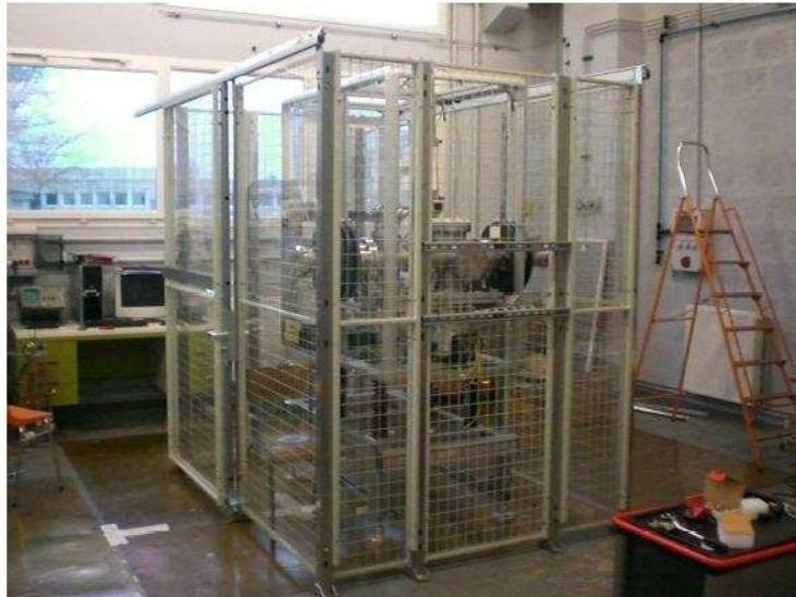
Figure 36 : Première modification au LPC : rotation du quadripôle et installation de l'ensemble d'extraction.
