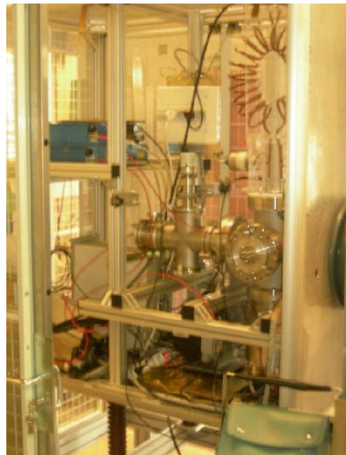
Figure 35 : Arrangement mécanique au CSNSM – sur la CAO, on distingue en mauve l'isolant HT situé à l'injection. Le quadripôle est logé dans l'ensemble de pièces de vide. La bride DN100 en fin de ligne supporte une coupe de Faraday recueillant les ions extraits juste après la sortie du cône d'extraction.
