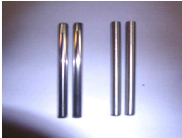
Figure 50 : Électrodes utilisées : (à gauche) le poli-miroir et (à droite) le Ra 1.6.
