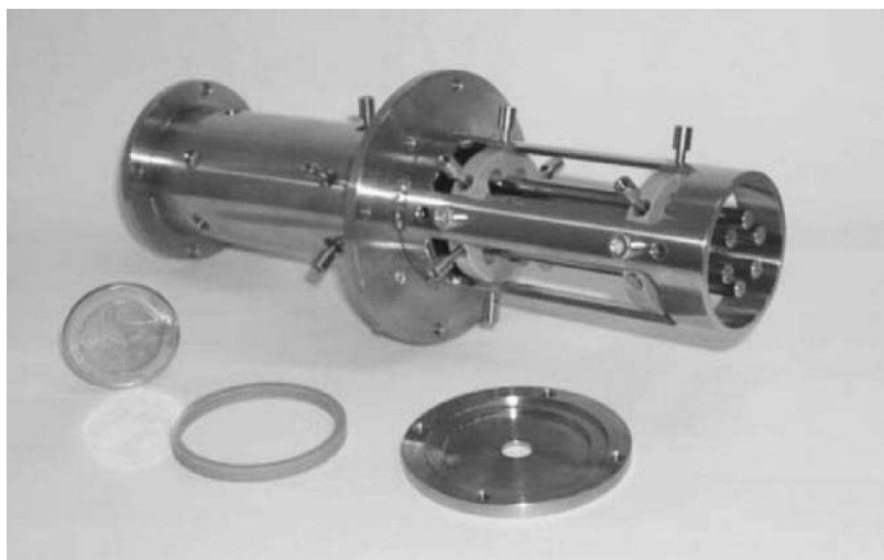
Figure 16 : SPIG [Kar08]. Sur la droite, nous pouvons distinguer la structure hexapolaire du dispositif.
