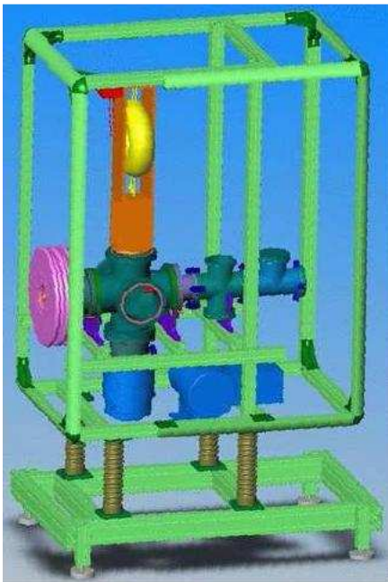
Figure 35 : Arrangement mécanique au CSNSM – sur la CAO, on distingue en mauve l'isolant HT situé à l'injection. Le quadripôle est logé dans l'ensemble de pièces de vide. La bride DN100 en fin de ligne supporte une coupe de Faraday recueillant les ions extraits juste après la sortie du cône d'extraction.
