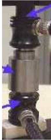
Fig. 1.7: œdomètre et mesures ultrasonores
