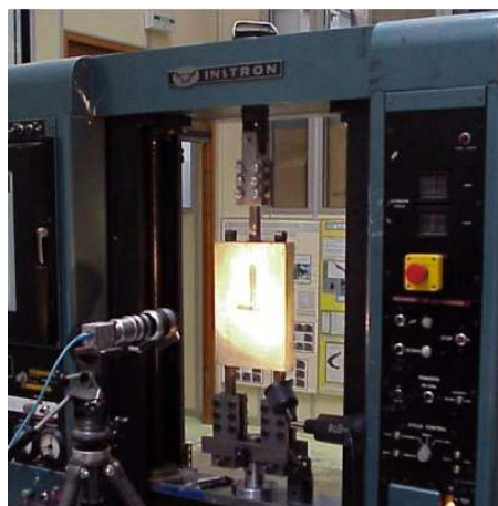
Fig. 1.10: Essai d'arrachement sur barres corrodées.
