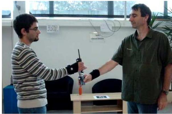
FIGURE 4.8 – Deux personnes s’échangent Bidule, ici Bidule et les deux personnes sont équipées de marqueurs pour la capture de mouvement.
