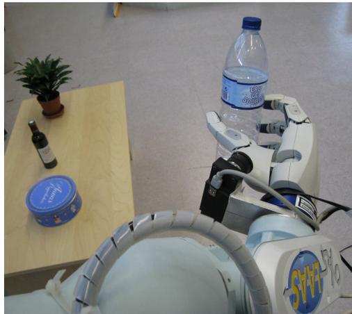
FIGURE 3 – Main Schunk SAH au bout du bras de Jido
