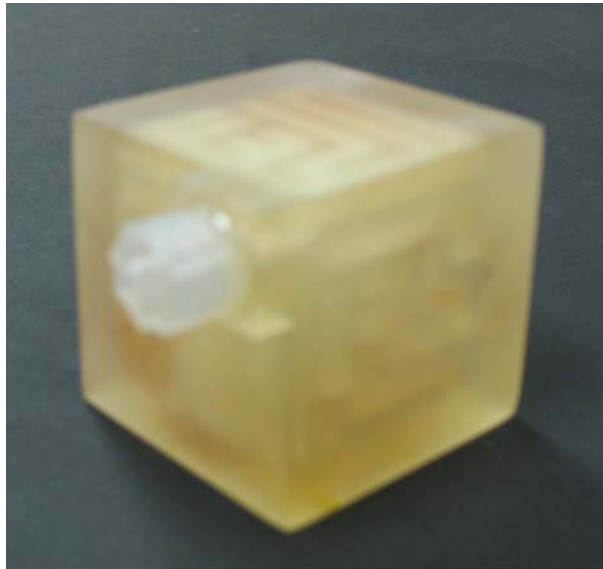
Figure 3-14 Fantôme #1 en résine époxy, réalisé par stéréolithographie.
