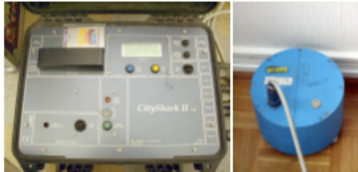
Figure 76: Station CityShark II connecté à un capteur 3 composantes Lennartz 5 secondes.
