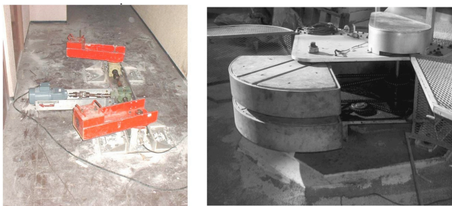
Figure 49: Dispositif d'excitation placée au sommet de la Milikan Library par Housner (droite) et dispositif plus léger utilisé par l'ENTPE (gauche).
