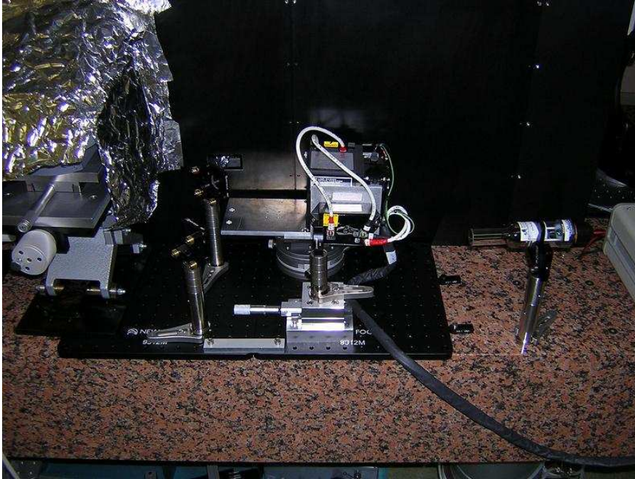
Fig. 7.18: Photographie montrant la partie mise en forme des faisceaux UV à l'extérieur du capot protégeant la maquette.
