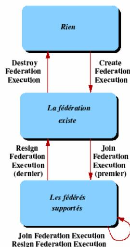
Figure 4.5 Le cycle de vie d'une simulation HLA
