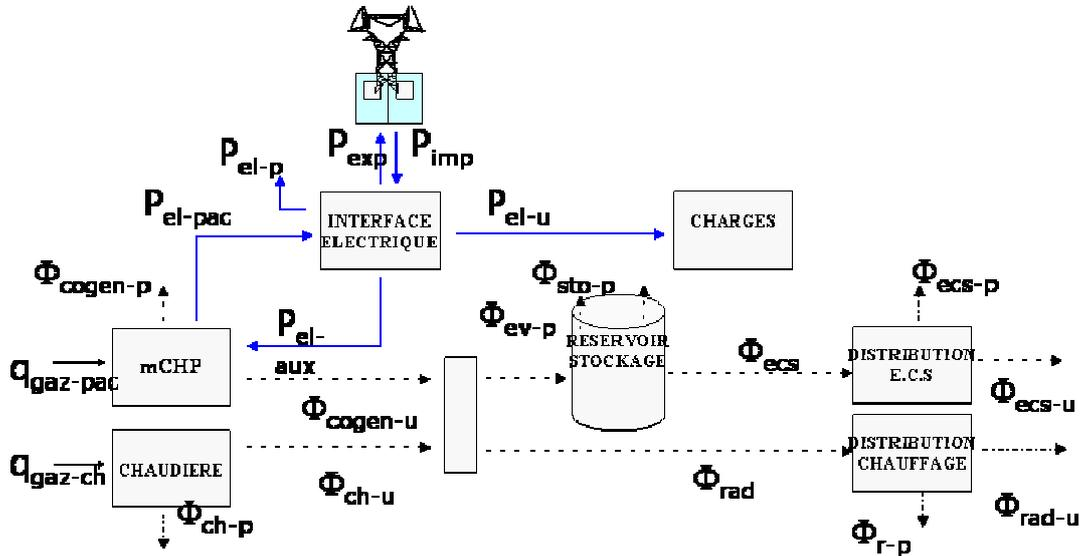
Figure 57: Modèle correspondant des flux énergétiques de l'installation
