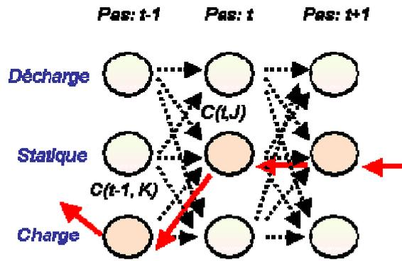
Figure 34: Principe d'optimisation par PD de la « trajectoire » de la batterie
