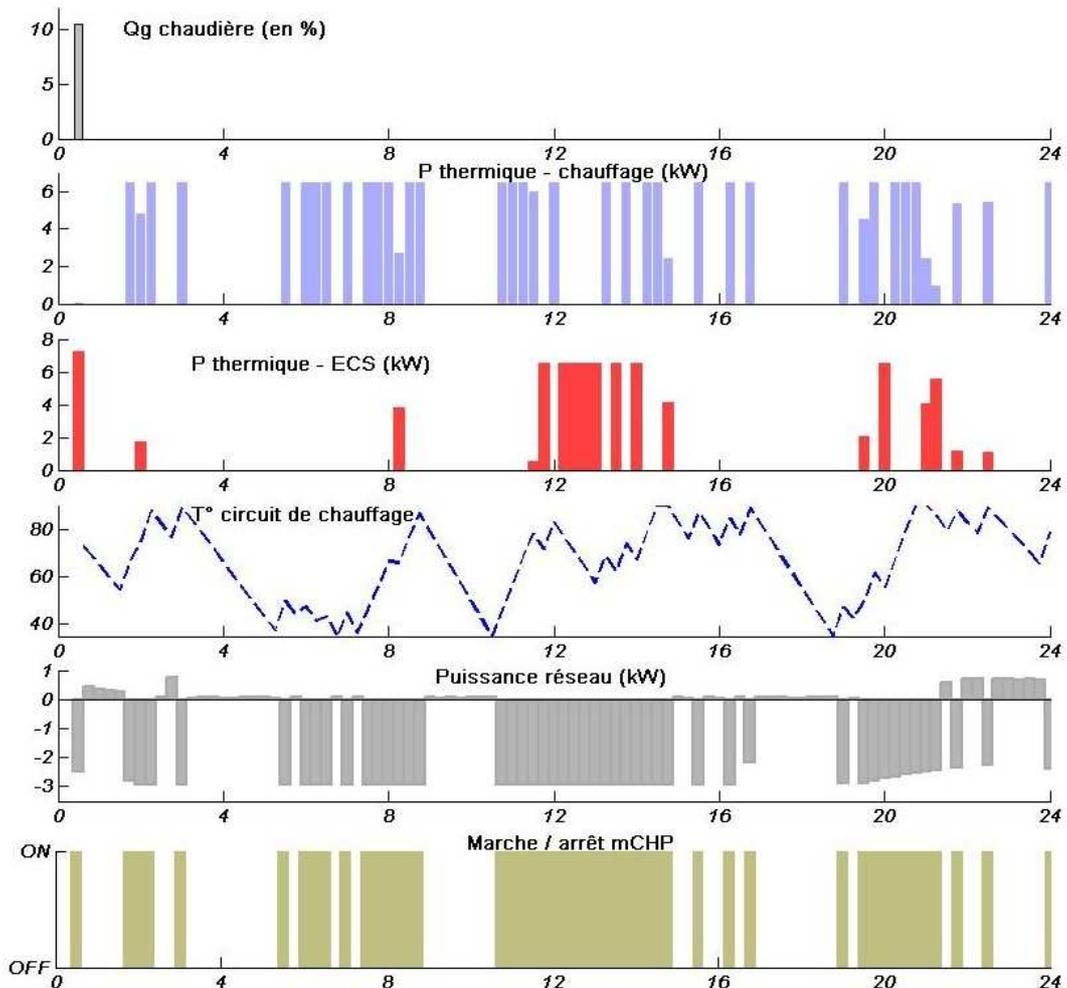
Figure 60: Evolution du système sur une journée – solution optimale (pas de temps = 15 min)
