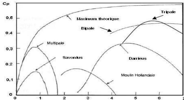
Figure 73 : Courbes caractéristiques des types d'éoliennes
