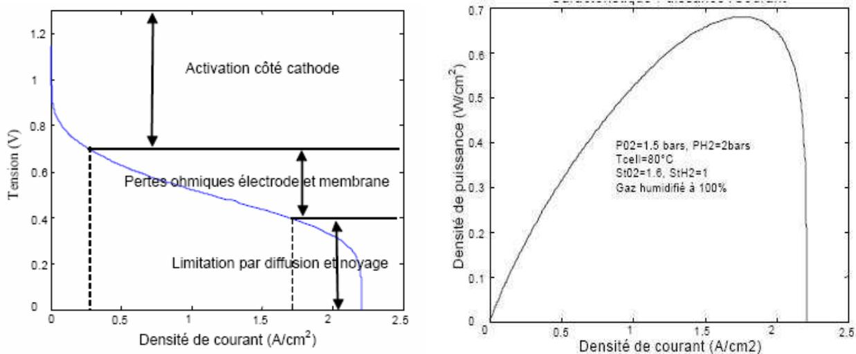
Figure 78 : courbe caractéristique tension-courant de la pile à combustible [LACH-04] (gauche) – caractéristique puissance – densité de courant (droite) [LACH-04]
