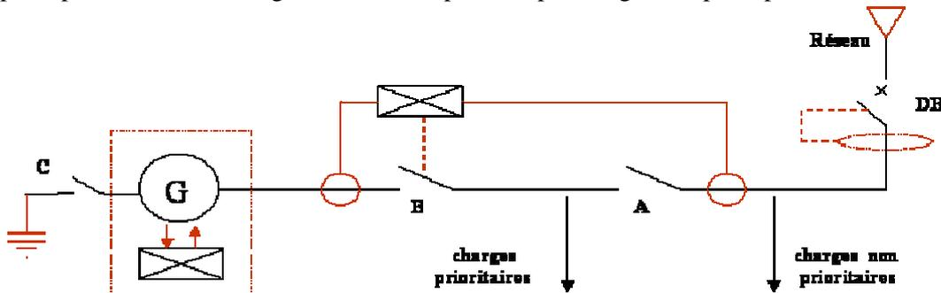
Figure 64 : schéma de principe de connexion du générateur
