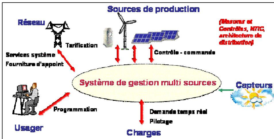
Figure 11: Schéma de principe du système de pilotage multi-sources
