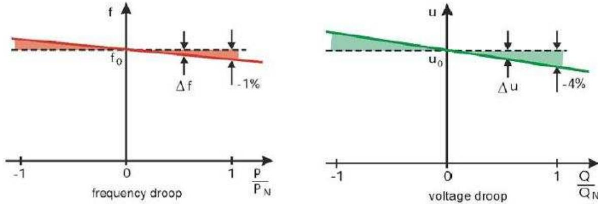
Figure 7: Principe de fonctionnement en statisme [PAPA-04]
