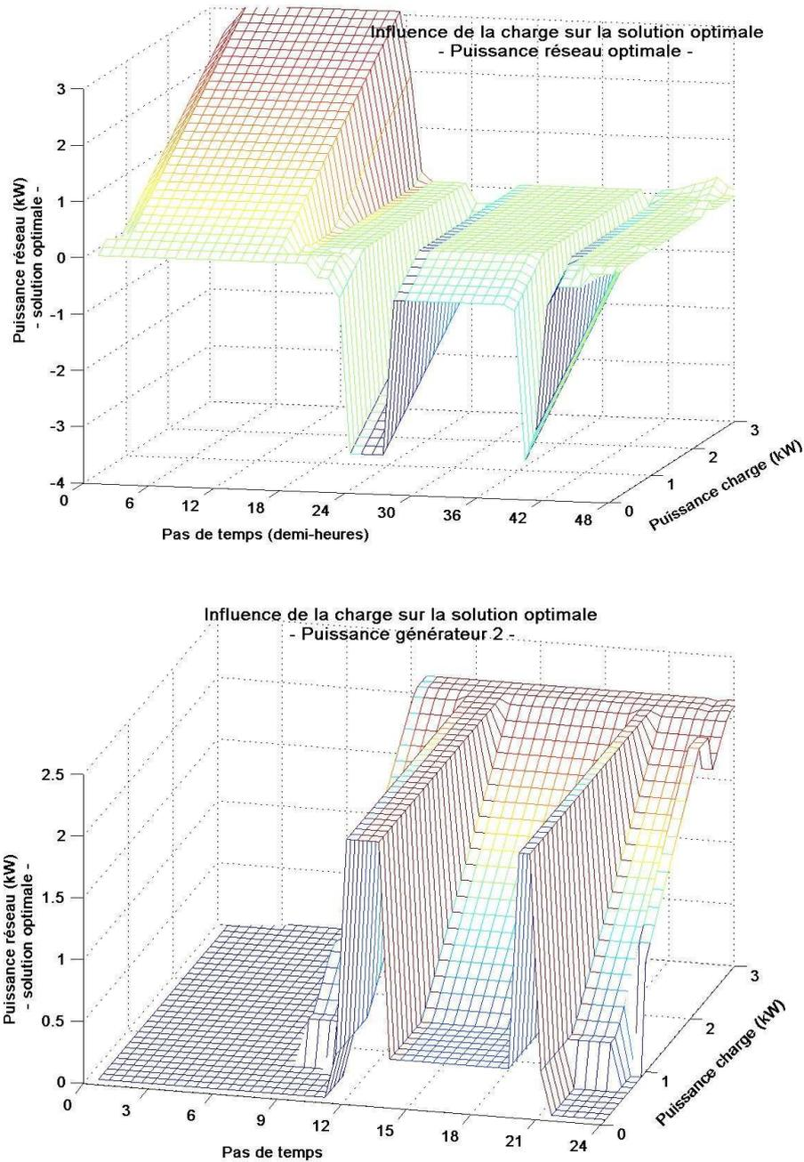
Figure 53: Influence des variations ponctuelles de charge autour de la solution optimale (Pres, Pg2)
