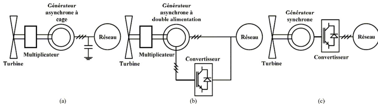
Figure 76: Différents types de systèmes éoliens. (a) à vitesse fixe avec machine asynchrone à cage, (b) à vitesse variable avec machine asynchrone à double alimentation, (c) avec machine synchrone à inducteur bobiné
