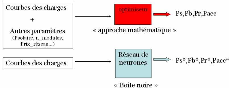
Figure 47 : Comparaison des approches avec optimisation / avec RN
