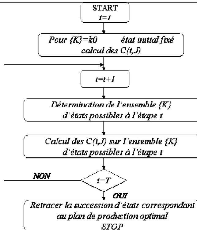
Figure 24 : Algorithme de résolution par programmation dynamique
