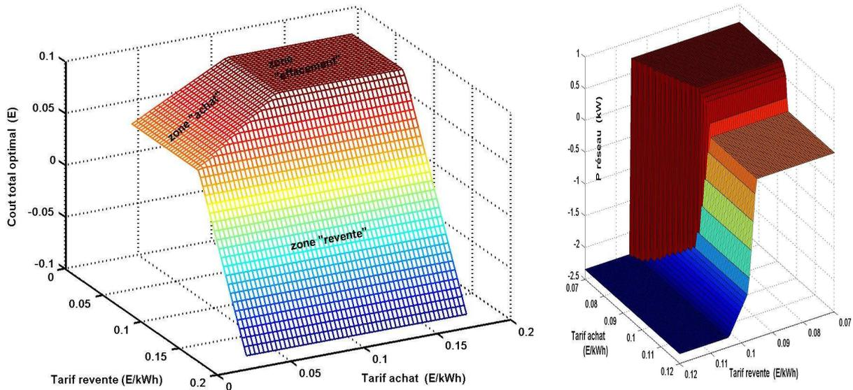
Figure 28: coût optimal et puissance échangée avec le réseau sur un pas de temps en fonction de la tarification ( $P_{ch}=1.04 \text{ kW}$ )
