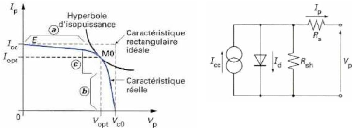
Figure 71 : Schéma équivalent d'une cellule photovoltaïque réelle
