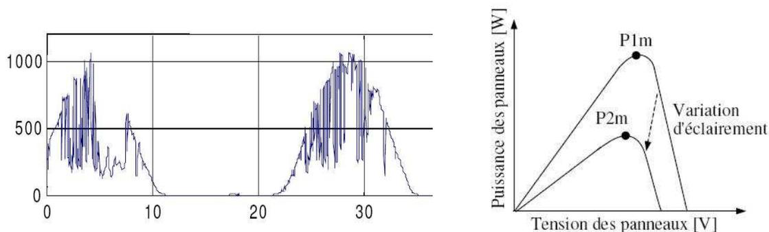
Figure 72: Courbes d'ensolaillement ( $W/m^2$ ) en fonction du temps (gauche) - Caractéristique de la puissance des panneaux PV (droite)
