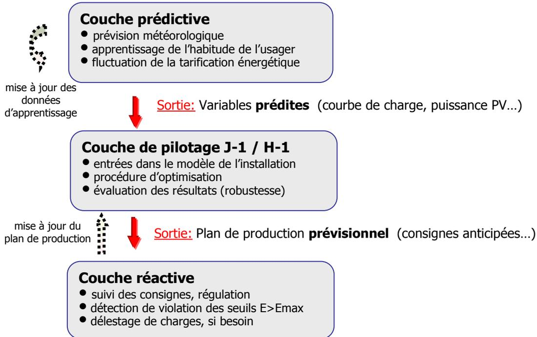
Figure 10: Architecture de commande à plusieurs niveaux
