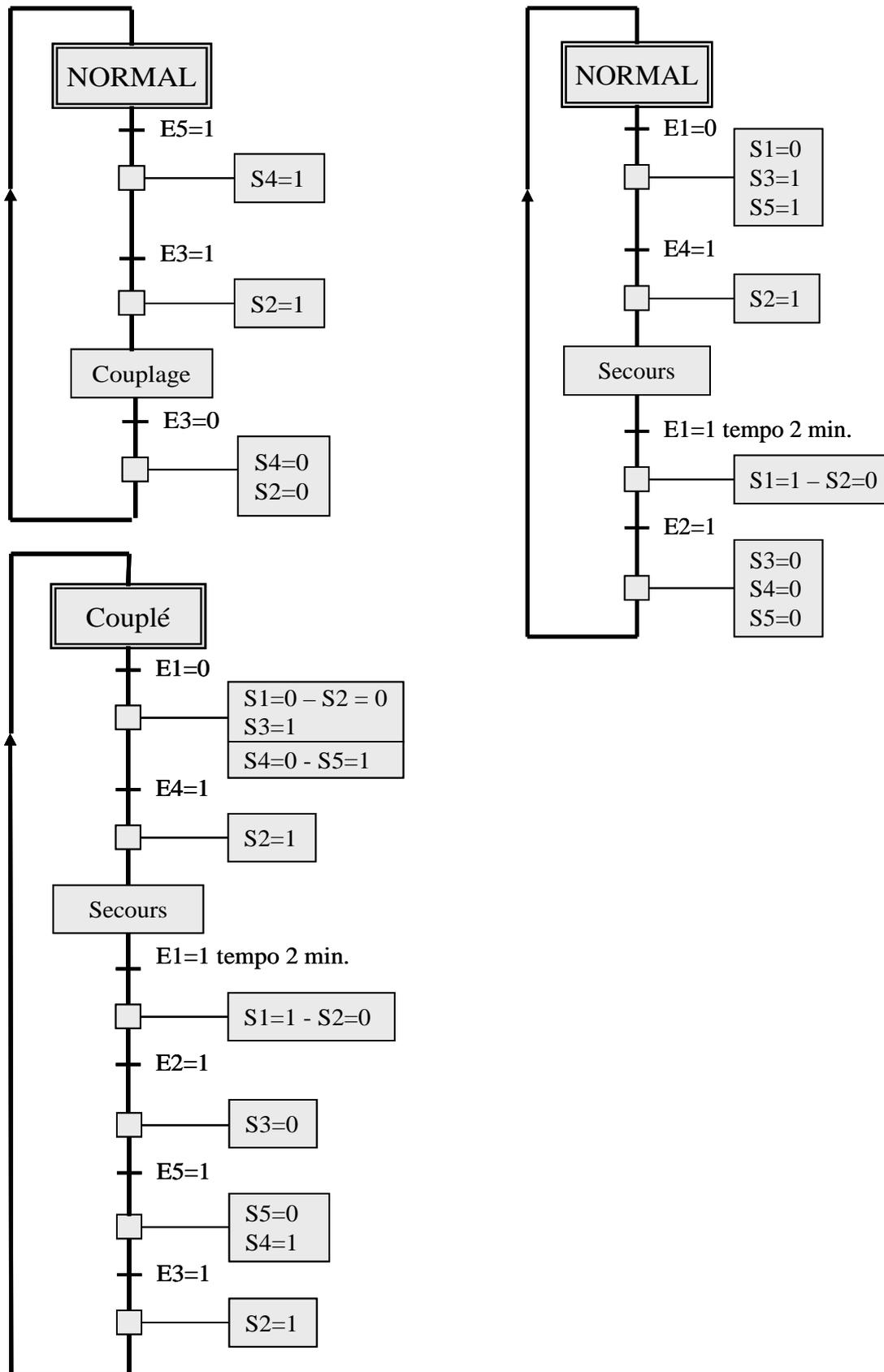
Figure 80 : Grafjets pour automatisme (sans mode DEFAULT) – Configuration 1
