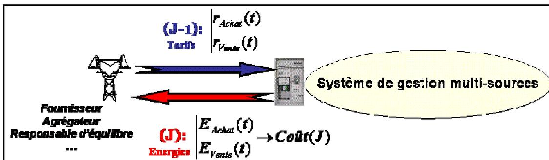
Figure 12: Communications nécessaires à une tarification dynamique
