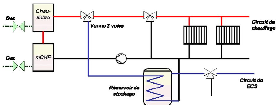
Figure 56: Schéma de principe de l'installation thermique
