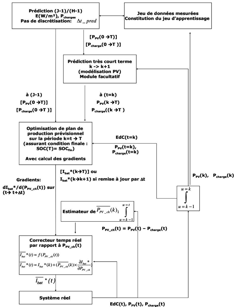
Figure 69: Flow chart de réalisation de la loi de commande de régulation de la batterie
