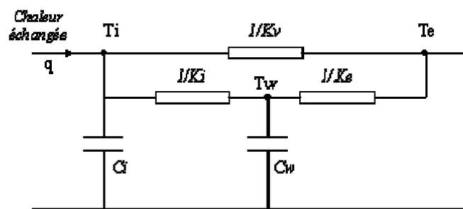
Figure 16: Modélisation physique du comportement thermique du bâtiment
