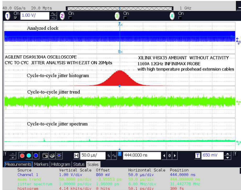
Figure 2-15 – Analyse de gigue cycle à cycle d'un RO implanté au sein d'un FPGA Xilinx V4SX35 porté à une température de 25°C.
