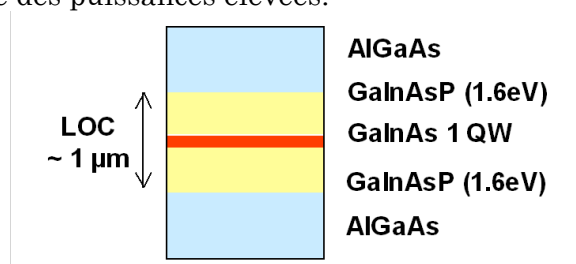
Figure III-1 : Structure verticale des diodes laser.
